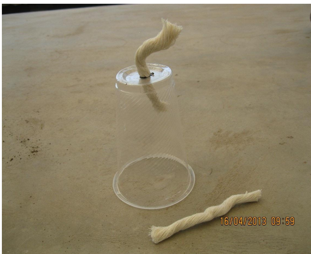
Figura 2.3. Maceta con pabalo para riego por capilaridad
