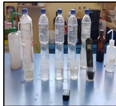
Medición de los parámetros fisicoquímicos (pH, T°, STD y conductividad)
