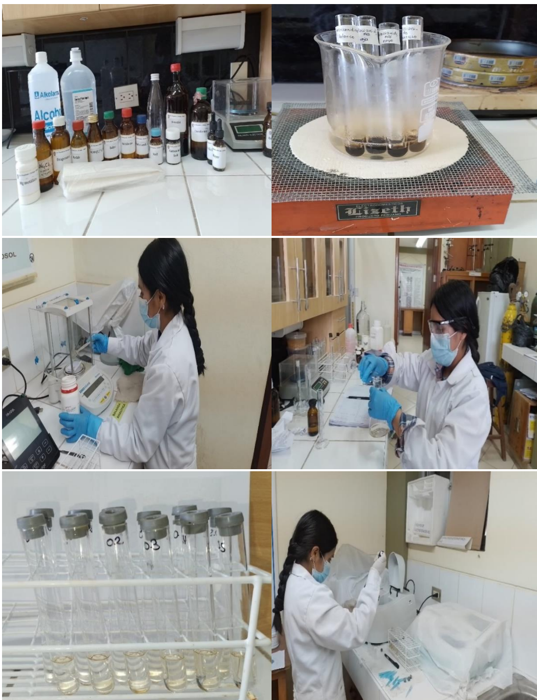
Anexo 25. Proceso del tamizaje fitoquímico de los extractos hidroalcohólicos secos y cuantificación de las saponinas de los cuatro cultivares de quinua.
