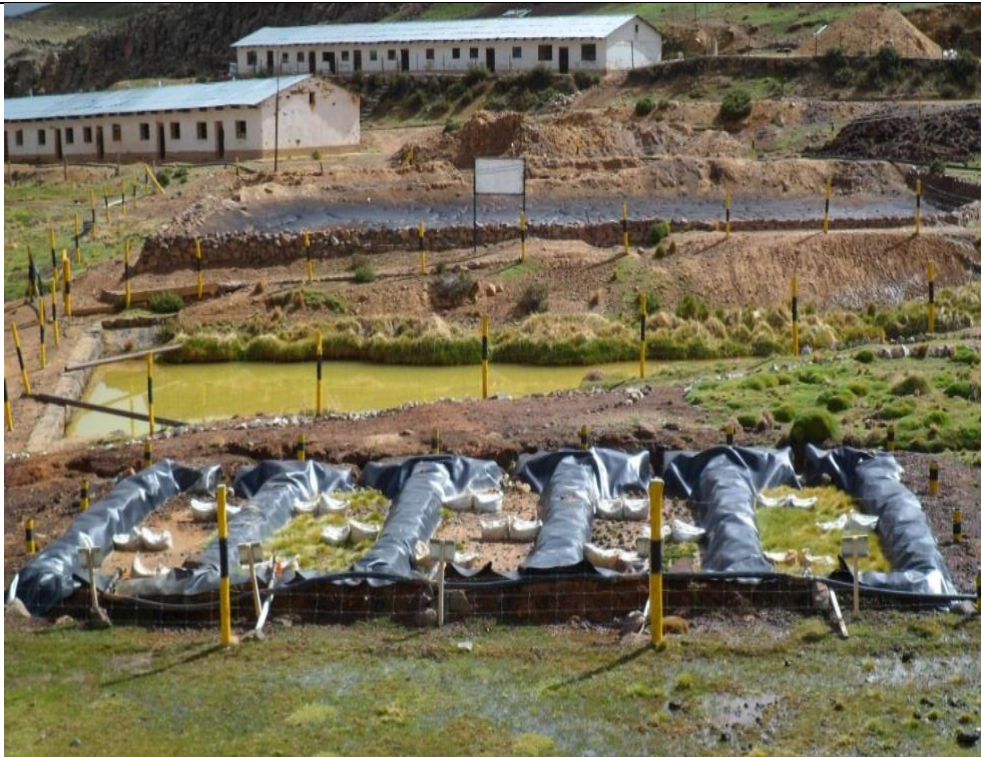
Fotografía 13. Estado de los tratamientos tras 10 semanas exposición a las aguas de la mina Pampamachay.
