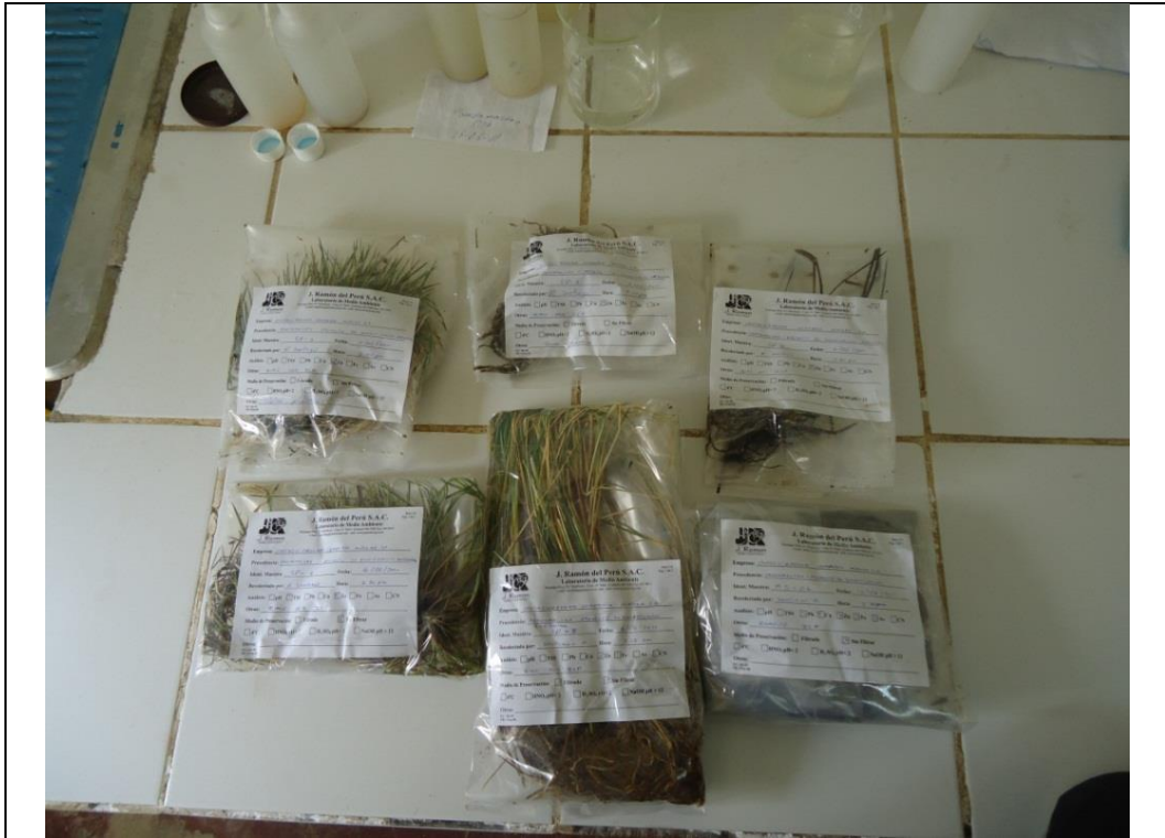
Fotografía 15. Material vegetal de cada uno de los tratamientos expuestos a las aguas de la bocamina Pampamachay
