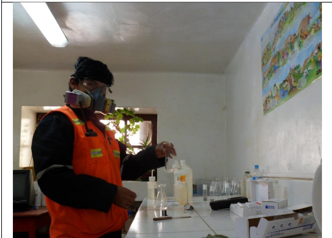
Fotografía 16. Tesista realizando la determinación de la concentración de zinc del efluente de cada uno de los tratamientos por el método del ZINCON.
