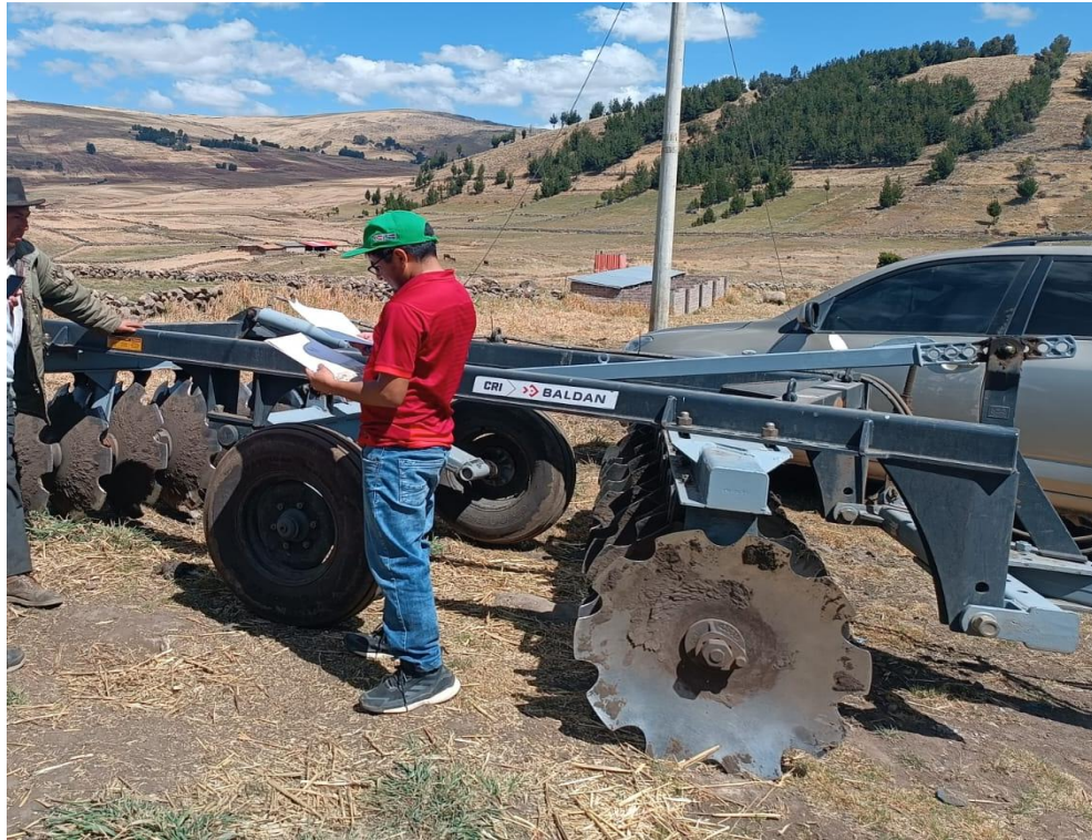
Figura 7 Falta de limpieza de la rastra aradora
