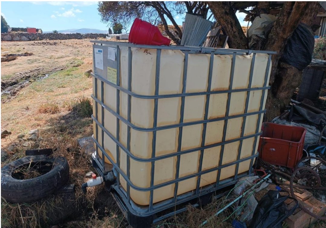
Figura 11 Envase donde se almacena combustible diésel a la intemperie.
