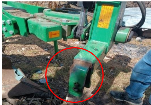
Figura 4. Soldadura del orificio de acoplamiento del arado de vertedera reversible
