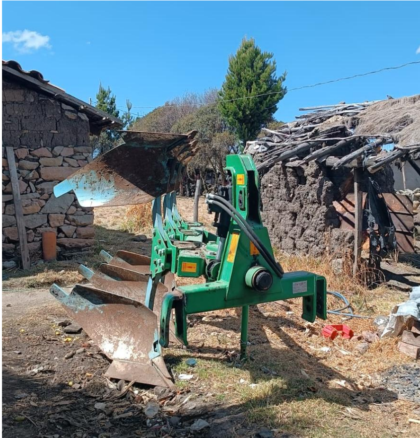
Figura 5 Falta de limpieza del arado de vertedera reversible
