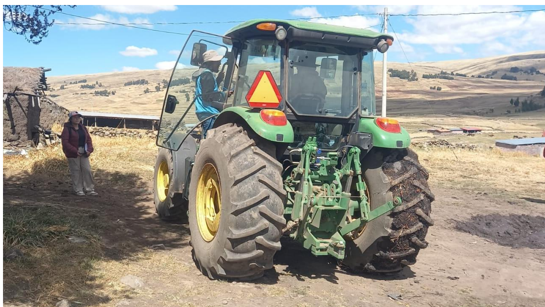
Figura 2 Falta de limpieza del enganche de tres puntos
