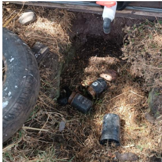
Figura 8 Engrasadora oxidada y filtros utilizados expuestos al aire libre
