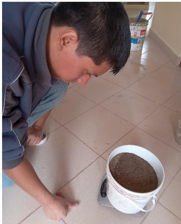
Registro de peso del testigo
