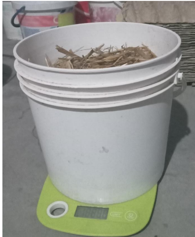
Figura 2.3 Evaporímetro de balanza
