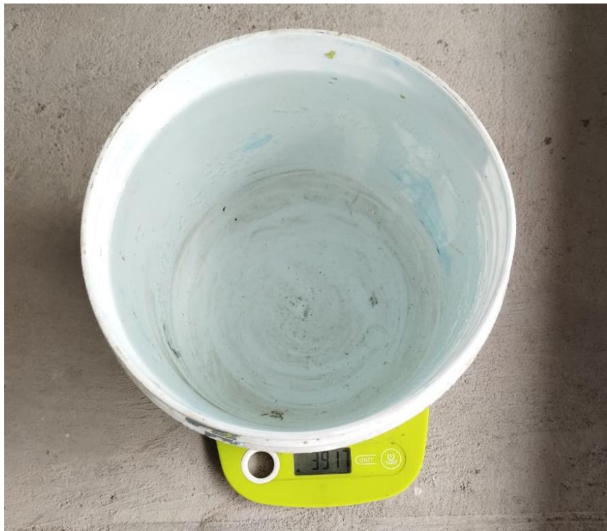
Pesado del tanque evaporímetro de agua casero
