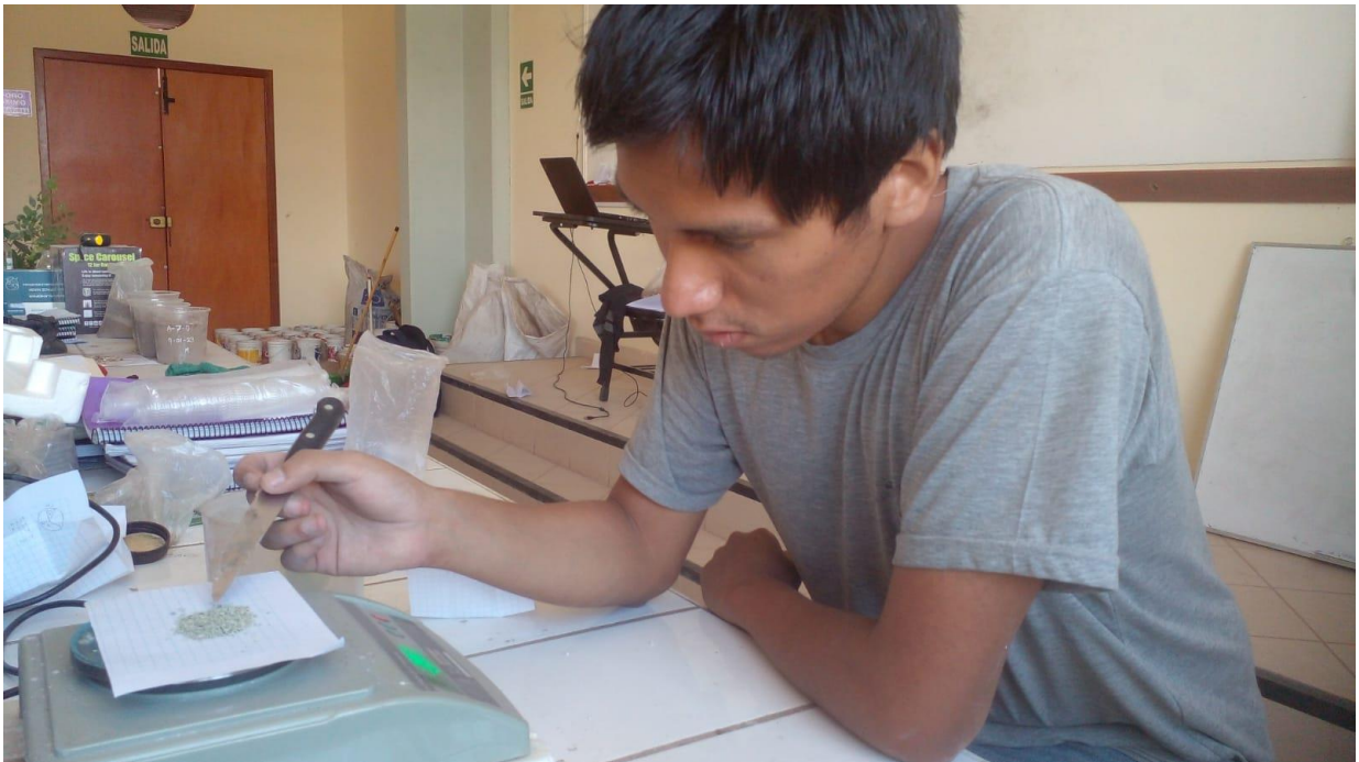
Medición de la dosis de zeolita para la aplicación en los tratamientos
