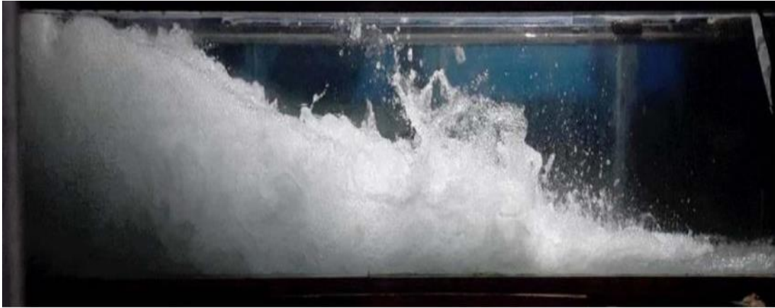
Figura 12 Resalto hidráulico intenso
