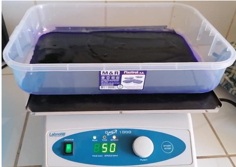
Fotografía 9. Proceso de coloración del gel de poliacrilamida con azul brillante de Coomassie durante 1 h a 50 RPM.
