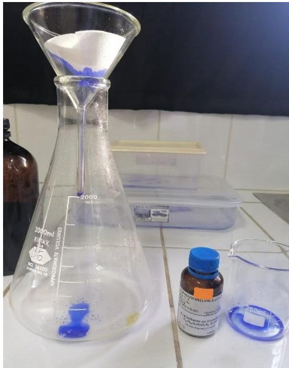
Fotografía 8. Preparación de coloración Azul de Coomasie G-250 para la tinción del gel de poliacrilamida SDS -PAGE.
