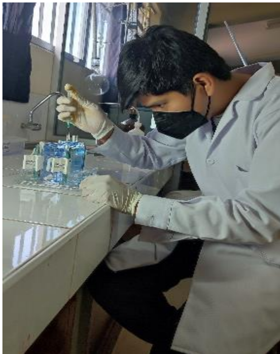
Fotografía 7. Añadido de muestras en los pocillos dentro de la placa de vidrio de la cámara de Electroforesis.
