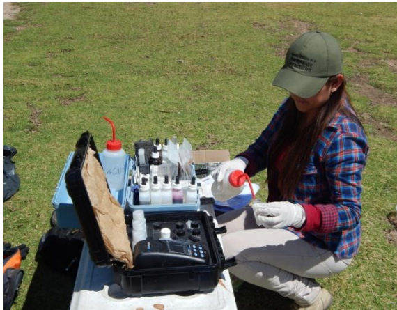
Fotografía 40. Análisis fisicoquímico con el equipo de HACH del agua de la laguna Pumacocha 2014.
