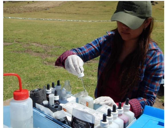
Fotografía 40. Análisis fisicoquímico con el equipo de HACH del agua de la laguna Pumacocha 2014.
