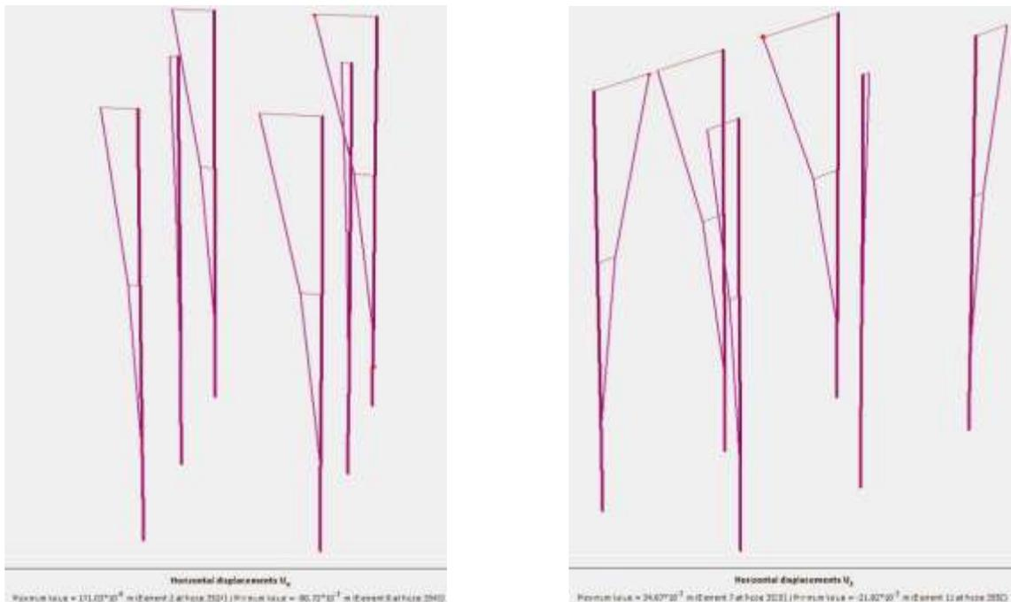
Figura 5.35: Deformaciones de pilotes a lo largo del eje: figura izquierda deformación en "x", derecho deformación en "y".
