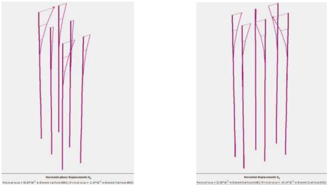
Figura 5.31: Deformaciones de pilotes a lo largo del eje: figura izquierda deformación en "x", derecha deformación en "y".
