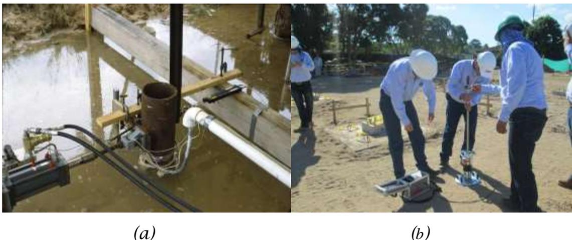
Figura 3.5: Determinación experimental del módulo de reacción lateral y vertical del suelo, a) Ensayos de carga lateral en pilotes a escala real; b) Ensayos de placa de carga.
