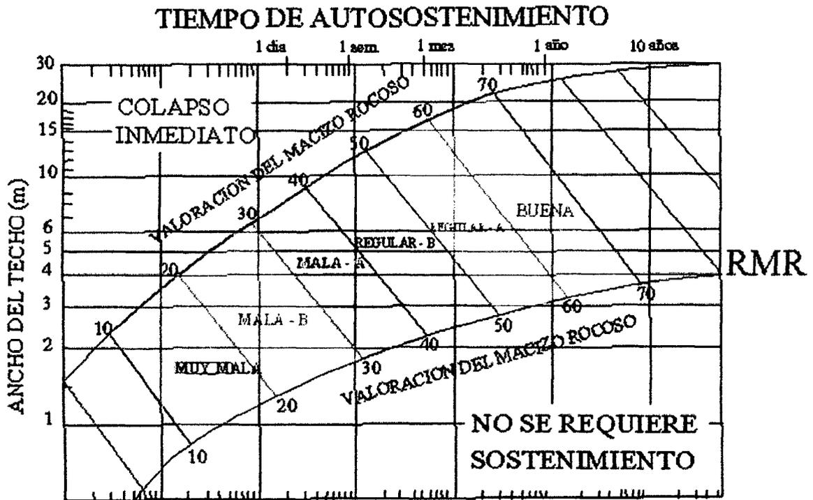
**Figura 2.20.** Longitud de la excavación y tiempos d estabilidad sin soporte.
