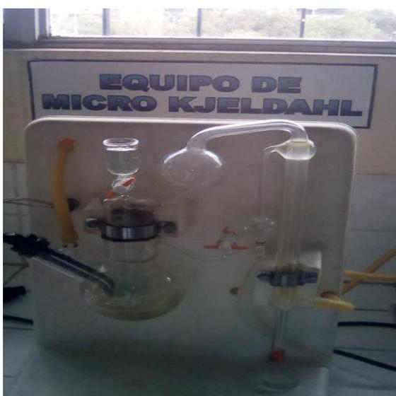
**Figura A13.5:** Destilación de la muestra.
