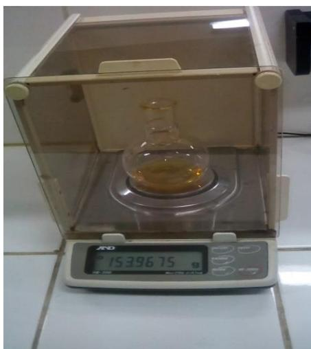
**Figura A13.33:** Peso del balón más la grasa extraída.
