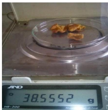
**Figura A13.13:** Pesado de la muestra final seca.
