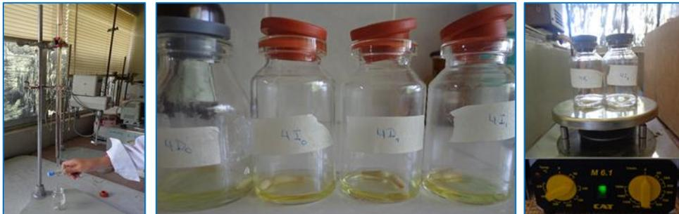
2. Adición de 2,5 mL de  $\text{HNO}_3$  al 5%. Calentamiento a  $65^\circ\text{C}$ .
