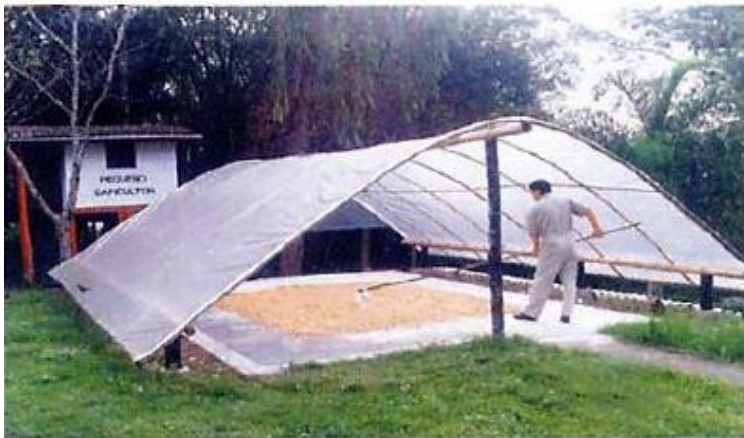
Figura n° 2.13: Secador solar con cubierta de plástico.
