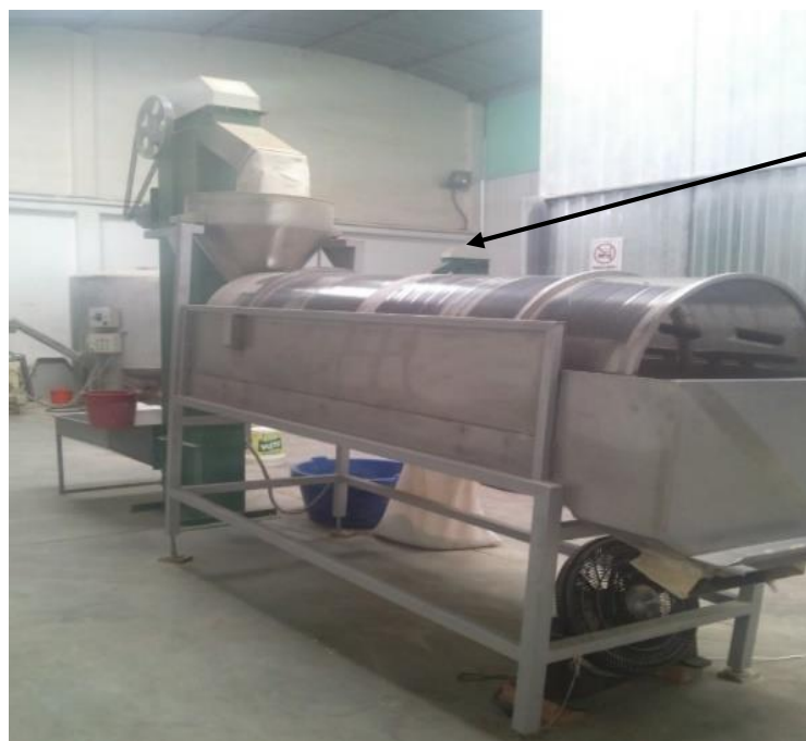
Figura n° 4.8: Vista de la seleccionadora de granos
