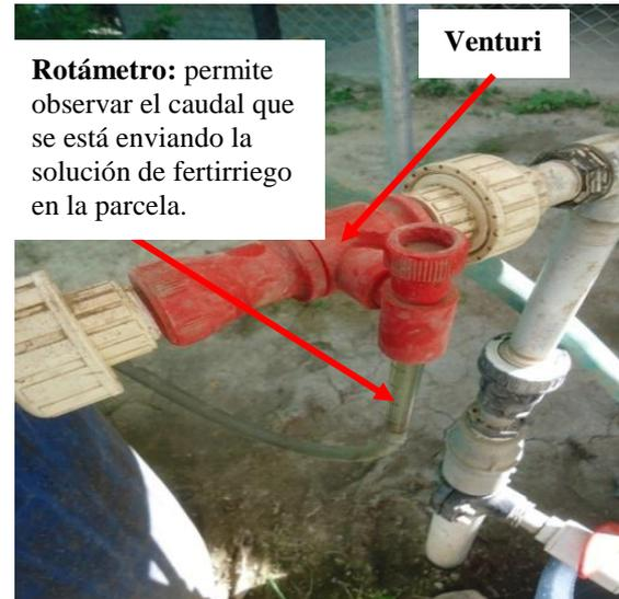
Figura 3.38. El Venturi regula el caudal con que se realiza el fertirriego.
