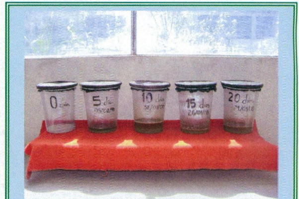
Foto 8: Proceso de incubación de la Roca Fosfórica en MEN Durante diferentes periodos: 0, 5, 10, 15, 20 días.
