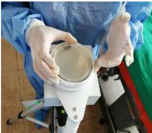
Observación de la placa Petri siendo colocada en el colector del equipo Spin air Basic.
