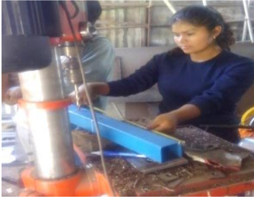
Figura 2.10. Perforación a la barra portaherramientas
