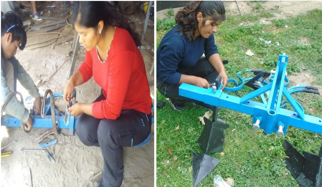
Figura 2.13. Adaptación de las rejas. Izquierda; escarificadora. Derecha; aporcadora
