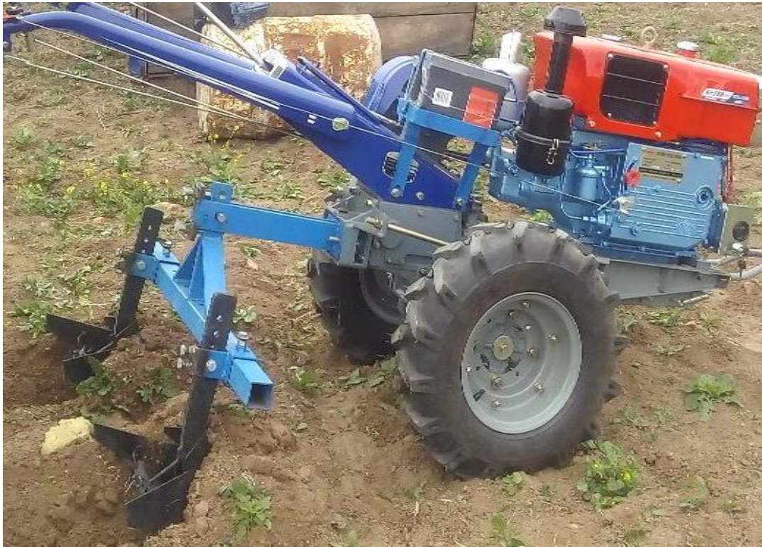
Figura 3.10. Vista lateral del acoplamiento tractor – cultivador con barra de tiro
