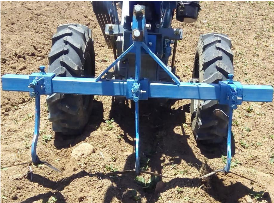
Figura 3.11. Vista posterior del acoplamiento tractor – cultivador con barra de tiro
