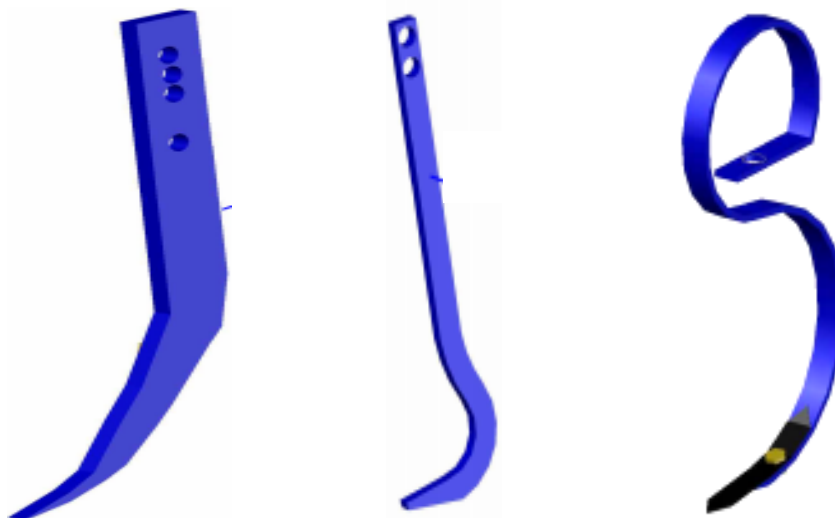
Figura 3.5. Brazos portaherramientas para el aporcador, extirpador y escarificador
