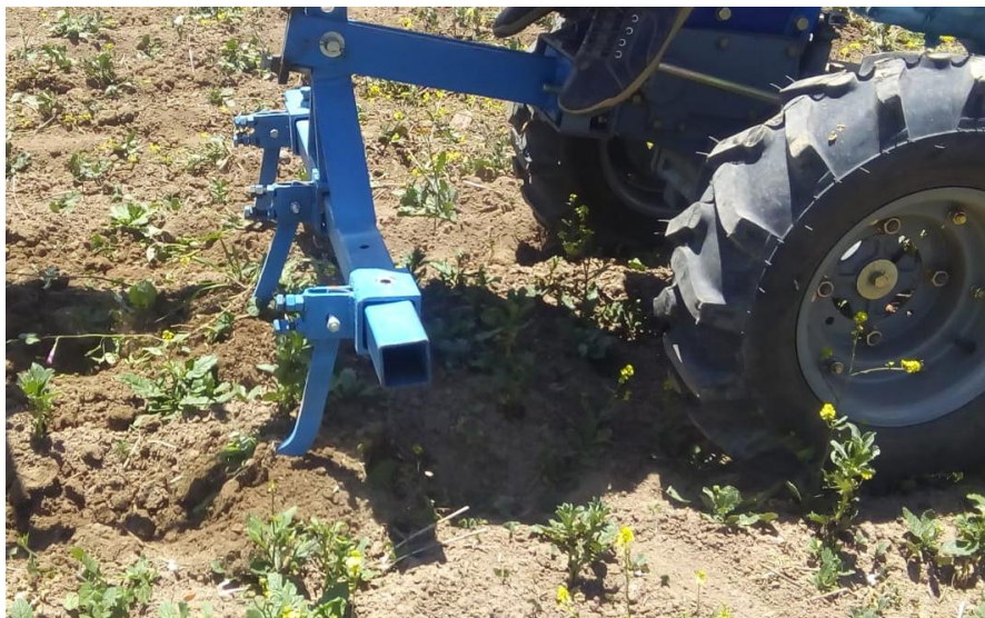
Figura 3.16. Resultados de aporque con la extirpadora al cultivo de haba
