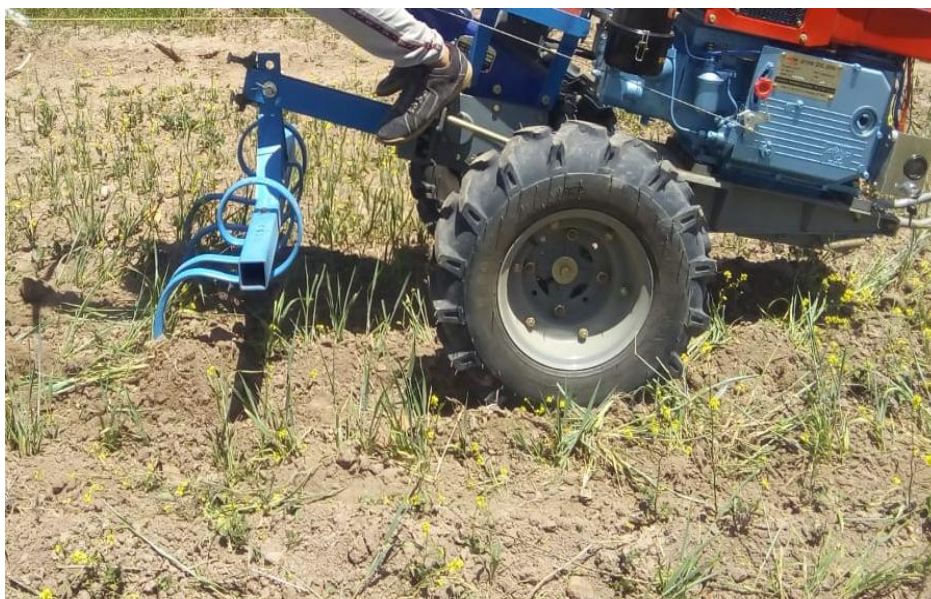
Figura 3.18. Resultados de aporque con la escarificadora al cultivo de trigo
