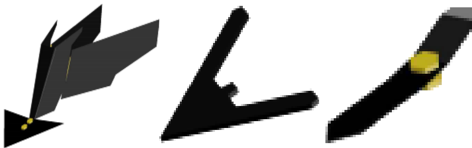
Figura 3.6. Reja o elemento de trabajo de la cultivadora: Aporcador, extirpador y escarificador
