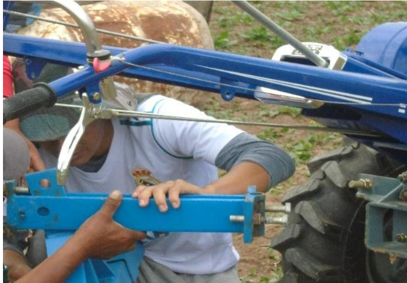
Figura 2.14. Acoplamiento mediante la barra de tiro al motocultor
