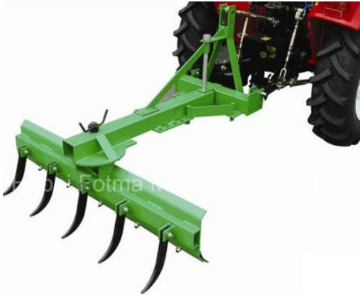
Figura 3.9. Acople en el enganche de tres puntos con control hidráulico
