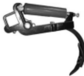
Figura 1.31. Brazo rígido vibrante con resorte
