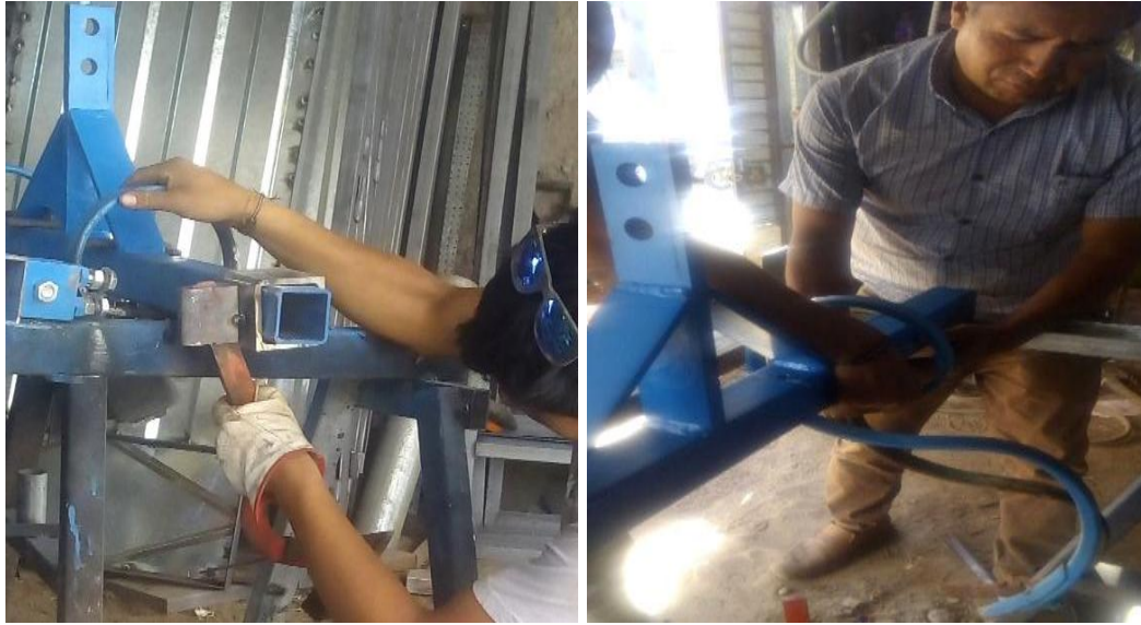
Figura 2.12. Adaptación de los brazos. Izquierda; brazo rígido. Derecha brazo flexible
