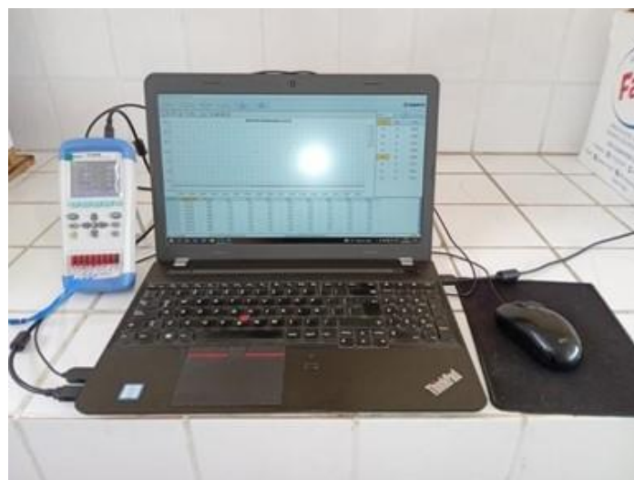
Figura 15. Conexión de Dataloger y equipo laptop.
