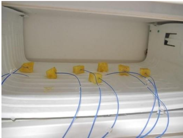
Figura 10. Montajes experimentales para congelación tradicional.
