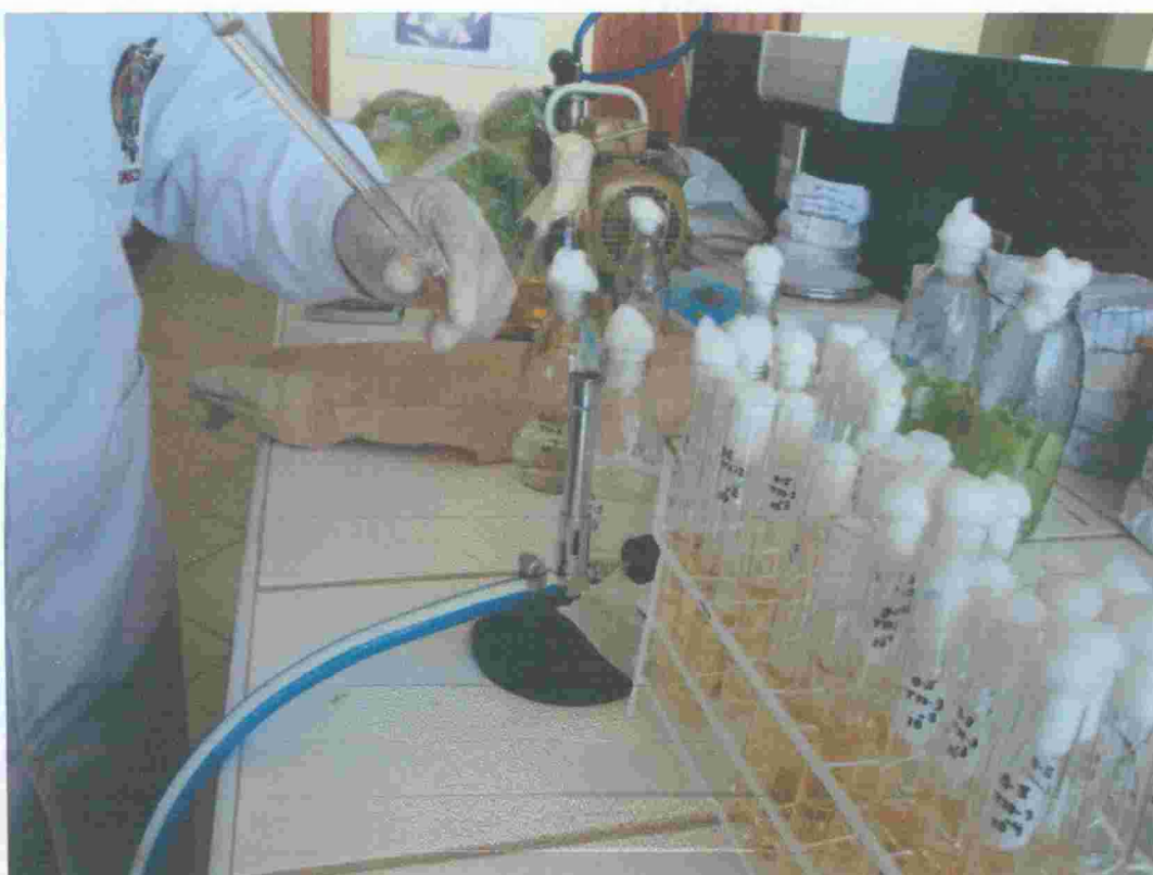
Fotografía Nº 7: Análisis de coliformes fecales y totales por la técnica de tubos múltiples en el laboratorio de Microbiología Ambiental de la UNSCH - Ayacucho – 2009 – 2010.
