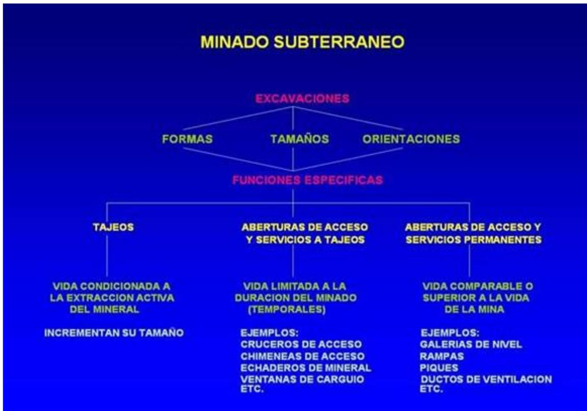
Figura 6. Esquema de Minado Subterráneo.
