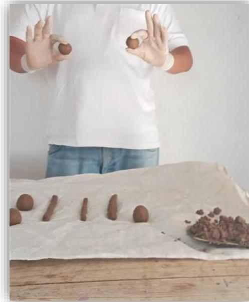
*Nota.* En la figura se visualiza la elaboración de las bolitas de tierra con diámetro de 3.40 mm, para luego dejar secar por 48 horas y finalmente realizar la prueba de presión de rotura a través del dedo pulgar y el dedo índice de la mano, comprobándose que el material suelo es apto.
