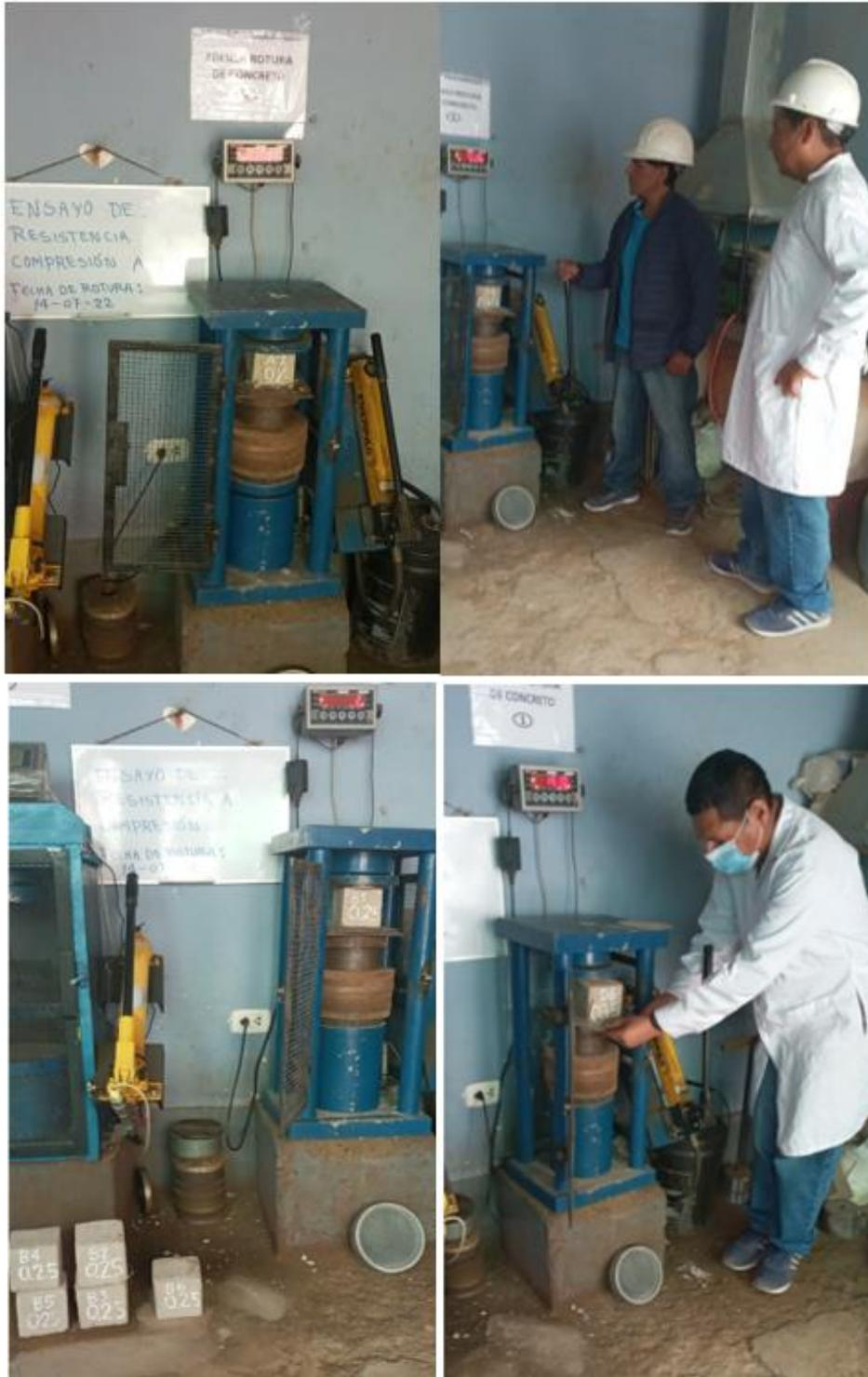
*Nota.* La figura muestra el proceso de ruptura de los bloques, desde la calibración de la máquina de ensayo, hasta la deformación del bloque, debido a la fuerza compresiva máxima alcanzada.
