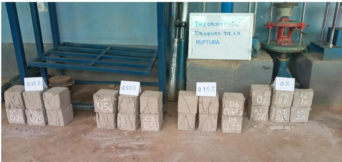
**Nota.** Se observa las diferentes deformaciones producidas por la fuerza compresiva
