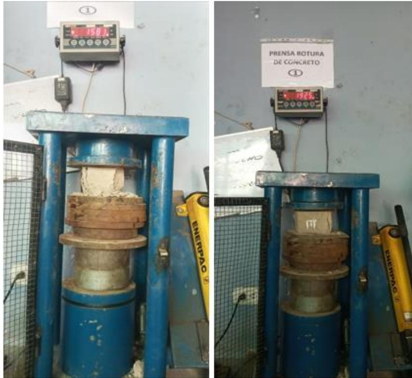
**Nota.** Se observa la Rotura del bloque de tierra, producto del esfuerzo máximo a compresión
