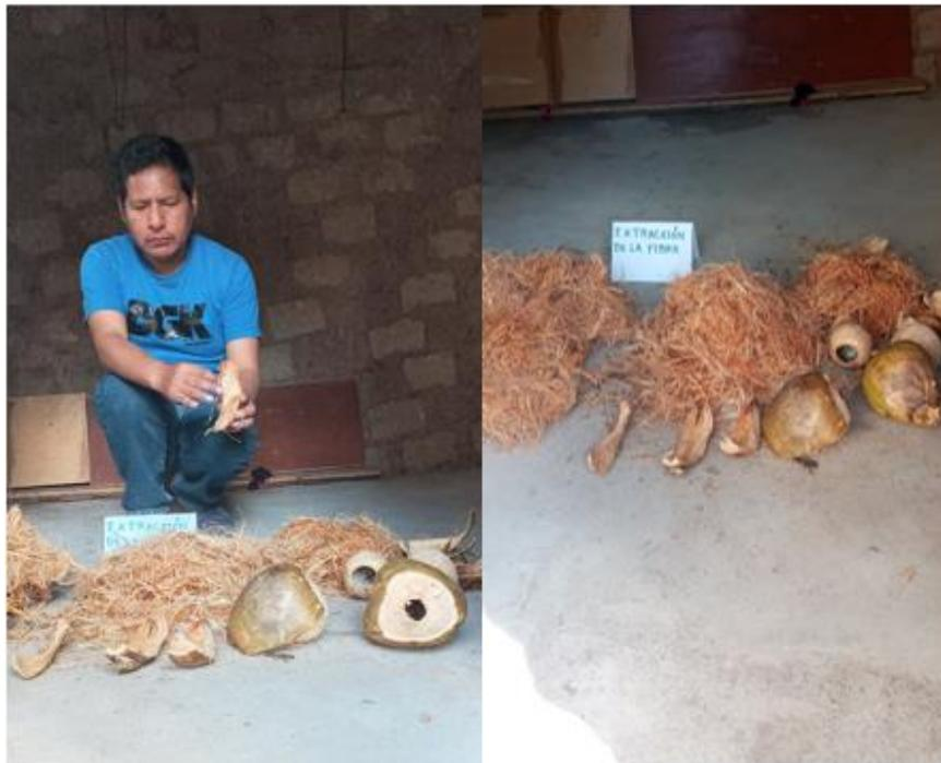
*Nota.* La Figura muestra el procedimiento manual de la obtención de la fibra de coco
