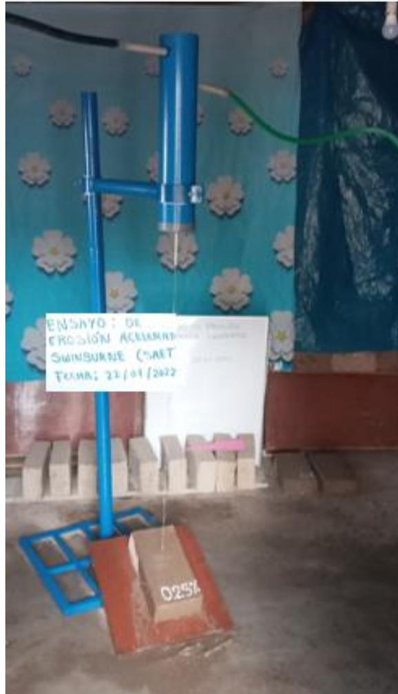
**Nota.** En la figura se muestra el equipo de ensayo de Erosión Acelerada Swinburne (SAET). El cual fue fabricada según los estándares de calidad contenidos en la Norma Española UNE 41410-2008.
