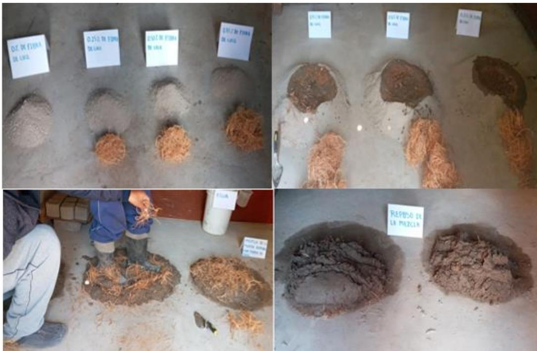
*Nota.* La Figura muestra el proceso de elaboración del adobe, desde la dosificación de sus componentes, hasta el proceso de mezclado y reposo de la mezcla.
