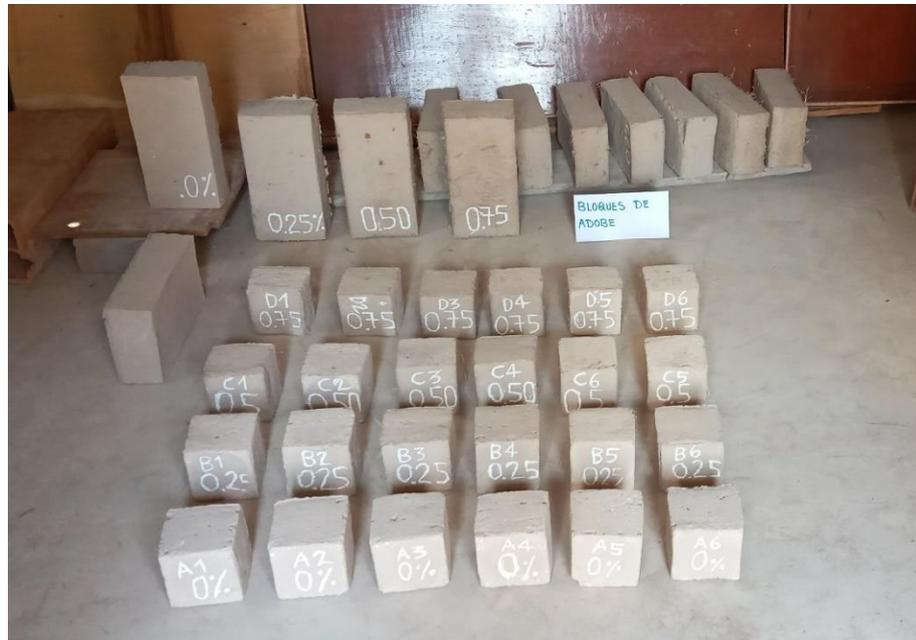
**Nota.** La figura muestra el proceso de secado de los bloques de adobe, por un tiempo de 28 días.
