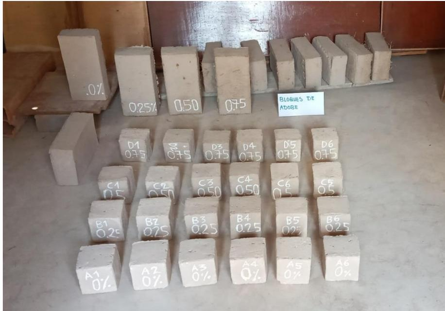
*Nota.* La figura muestra el proceso de secado de los bloques de adobe, en un tiempo de 28 días.
