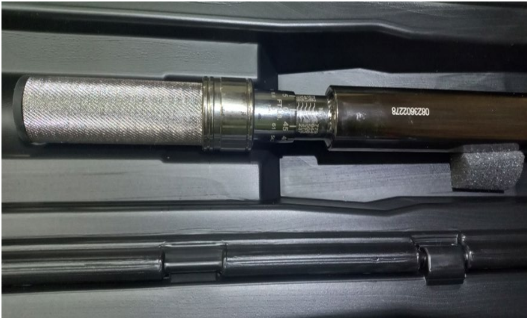
Figura 69. Torquimetro certificado para el torqueo de pernos de las estructuras metálicas en el Pique Carlos
