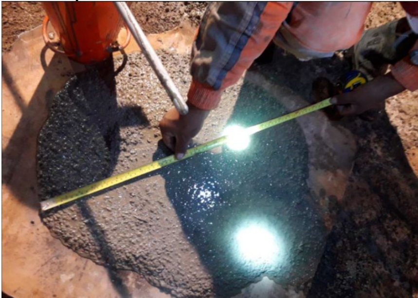
Figura 85. Medida de la expansión del concreto.
