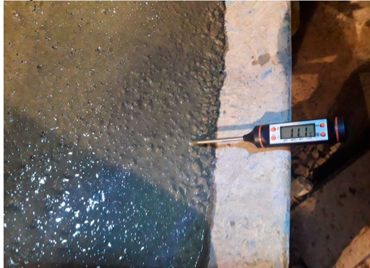
Figura 78. Determinación de temperatura.
