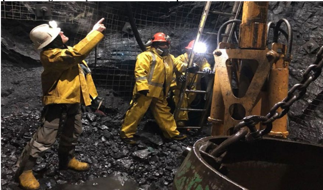
Figura 71. Limpieza de carga con Cryderman con baldes de profundización
