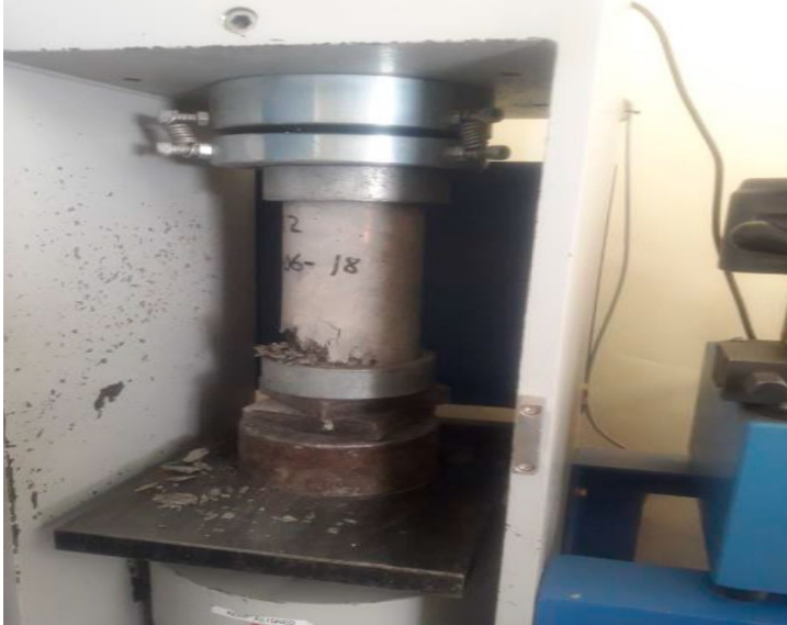
Figura 90. Resultado de Rotura de probetas
