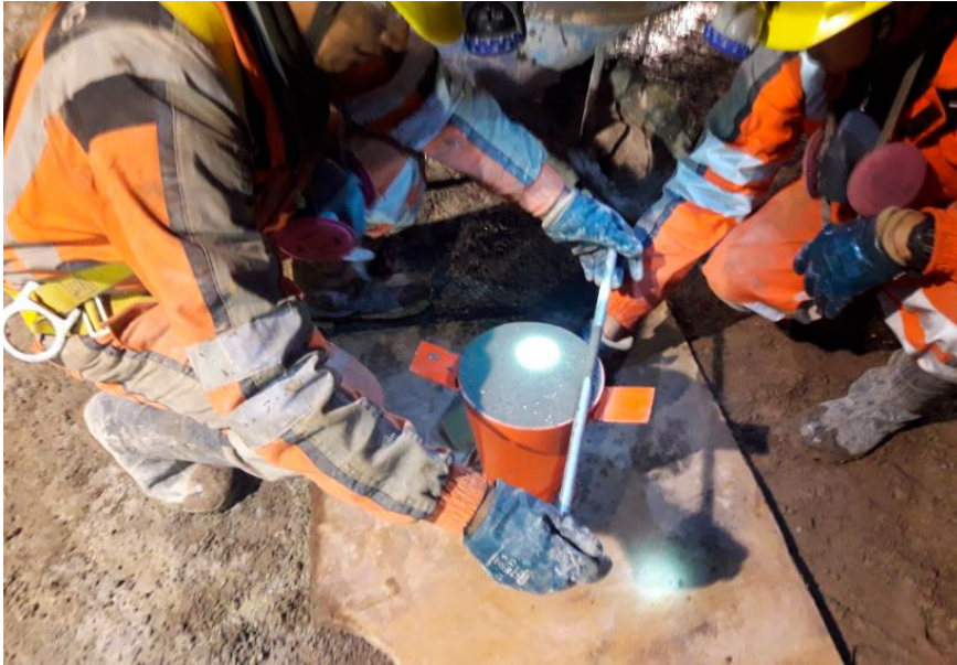
Figura 82. Colocación de concreto en el cono de Abrams
