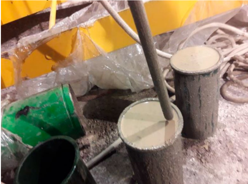
Figura 87. Elaboración de probetas
