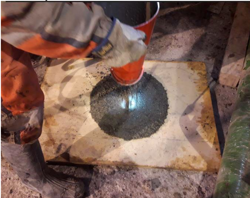
Figura 83. Medida de la expansión del concreto.
