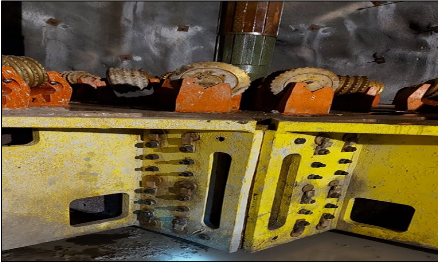
Figura 58. Equipo usado en el Rimado de Pique Carlos de 5.5m de rimado de sección
