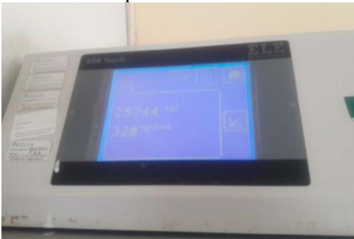
Figura 90. Resultado de Rotura de probetas
