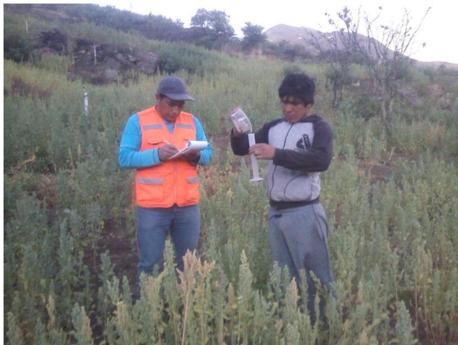
Foto 19. Evaluación de prueba de uniformidad de riego en un marco de 7 x 7, con total de 49 datos en riego por aspersión VYR 66, medición con probeta de 100 mililitros.
