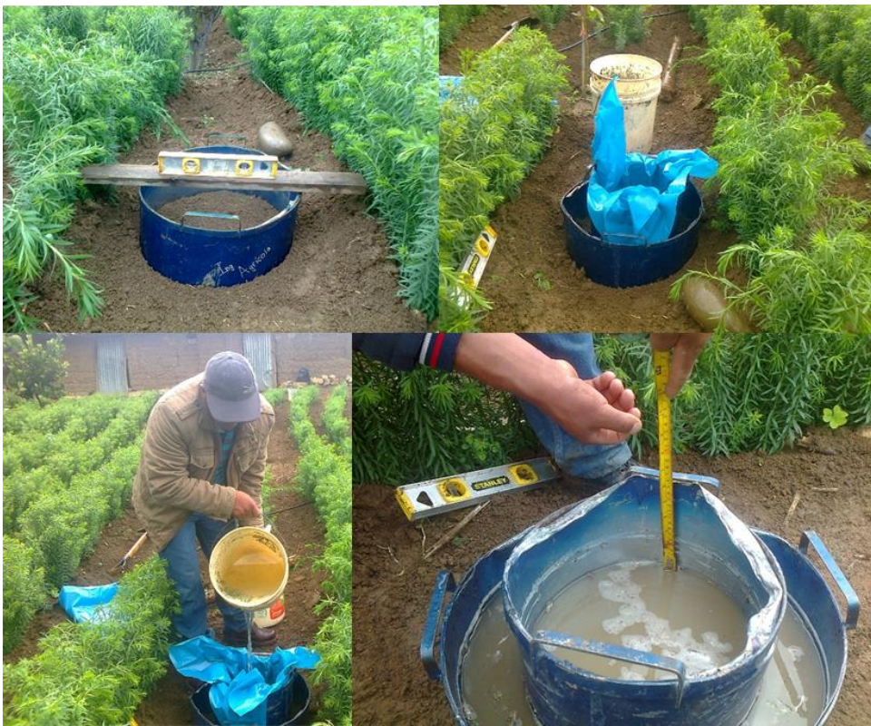
Foto 6. Instalación de cilindro infiltrómetro y el proceso de lectura del descenso de agua como se aprecia en el imagen.
