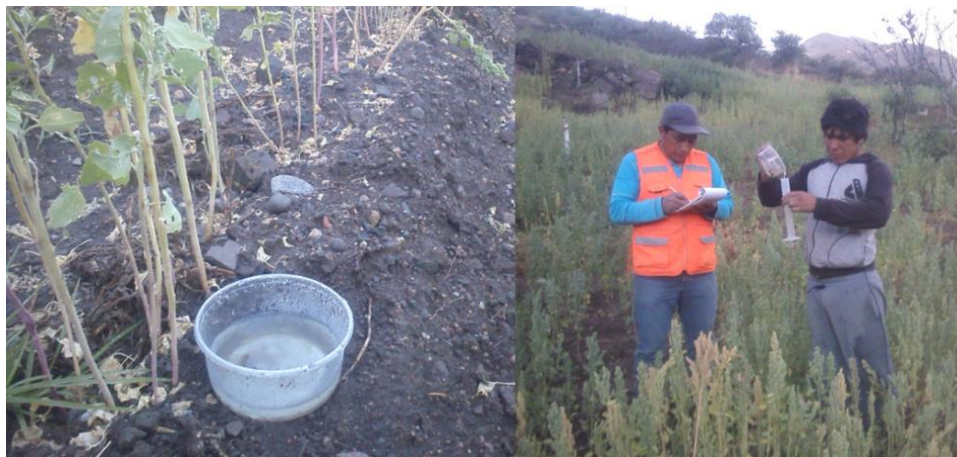
Figura 2.11: Lectura de pluviómetros con probeta de 100ml aspersión VYR 66
