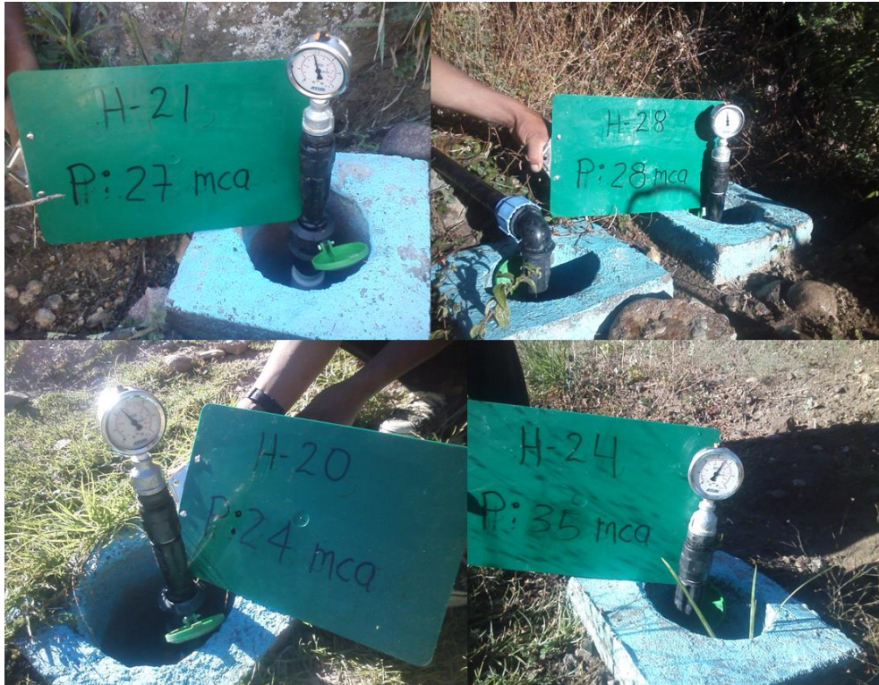
Foto 13. Evaluación de presiones dinámicas de funcionamiento en campo en los hidrantes con el uso de manómetro de 6.0 bares.
