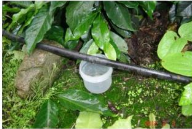
Figura 1.16: Medida de caudal que suministra los emisores en riego localizado
