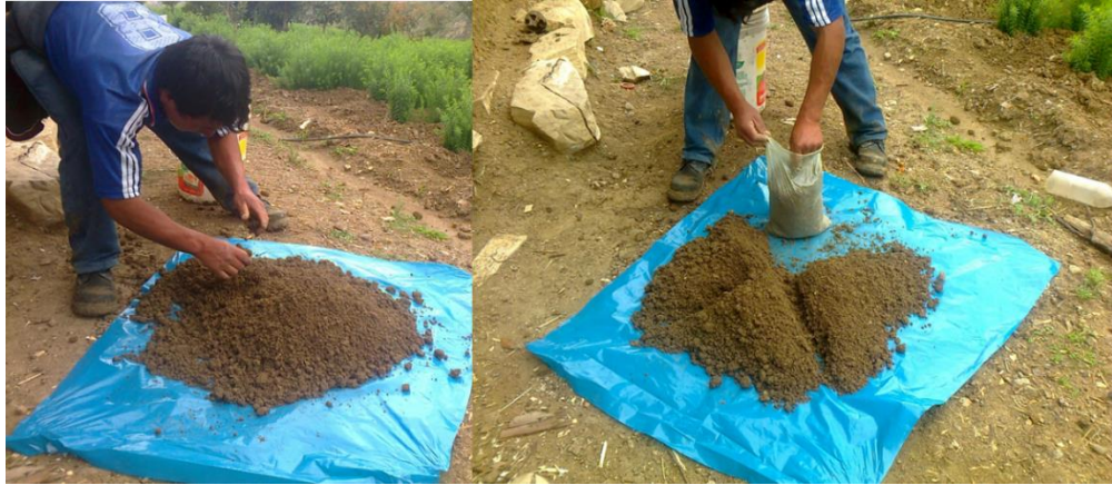
Foto 10. El cuarteo de la muestra recolectada representativa de toda el área de riego para ser llevado al laboratorio.
