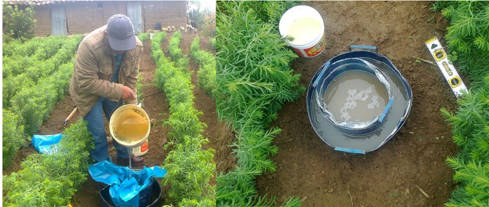
Figura 2.6: Llenado con agua a cilindro interior impermeabilizada con plástico y cilindro exterior
