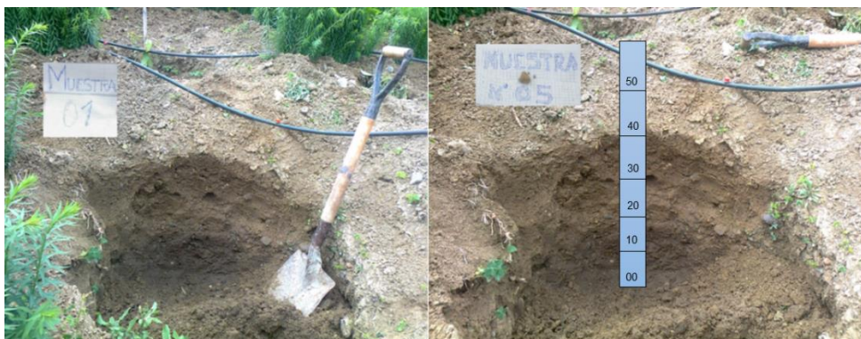
Figura 2.8: Característica, profundidad y extracción de suelo para laboratorio
