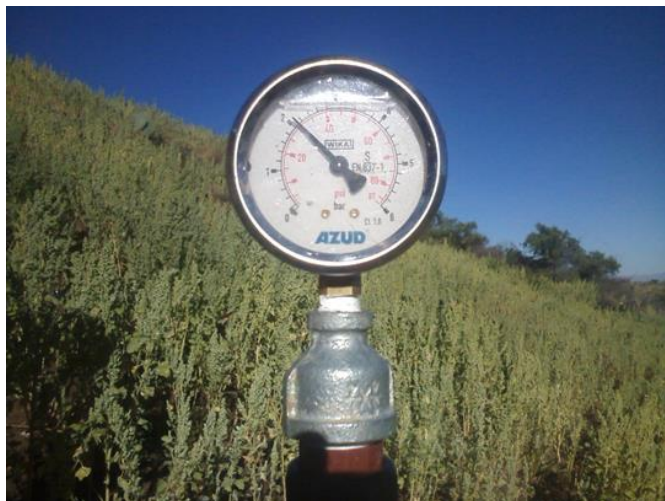
Foto 17. Evaluación de presión de operación en la subunidad de riego 12 aspersion VYR 66, con manómetro de 6.0 bares.
