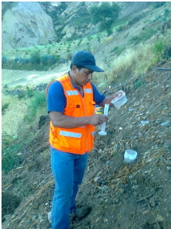
Foto 21. Lectura de lámina de agua en riego por aspersión Xcel Wobbler.
