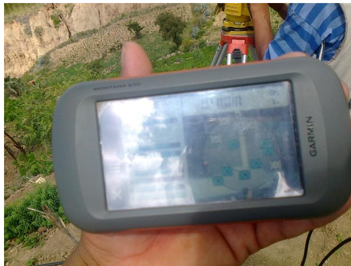
Figura 2.4: Delimitación de áreas de riego con GPS Montana 650
