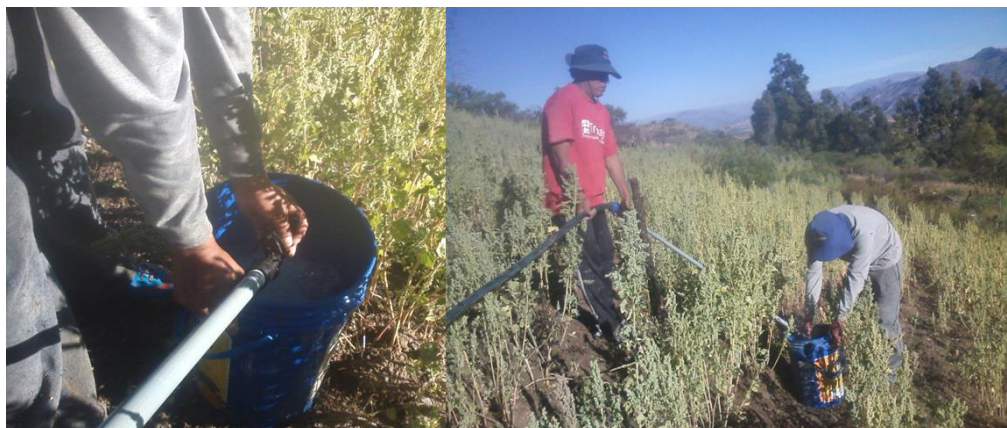
Foto 12. Medición de caudal en el aspersor VYR 66.
