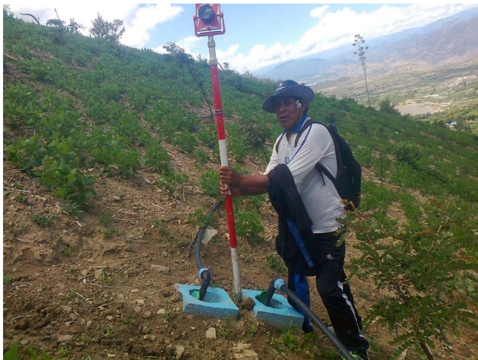
Foto 2. Ubicación de hidrantes con estación total, se observa el prisma tomando lectura.
