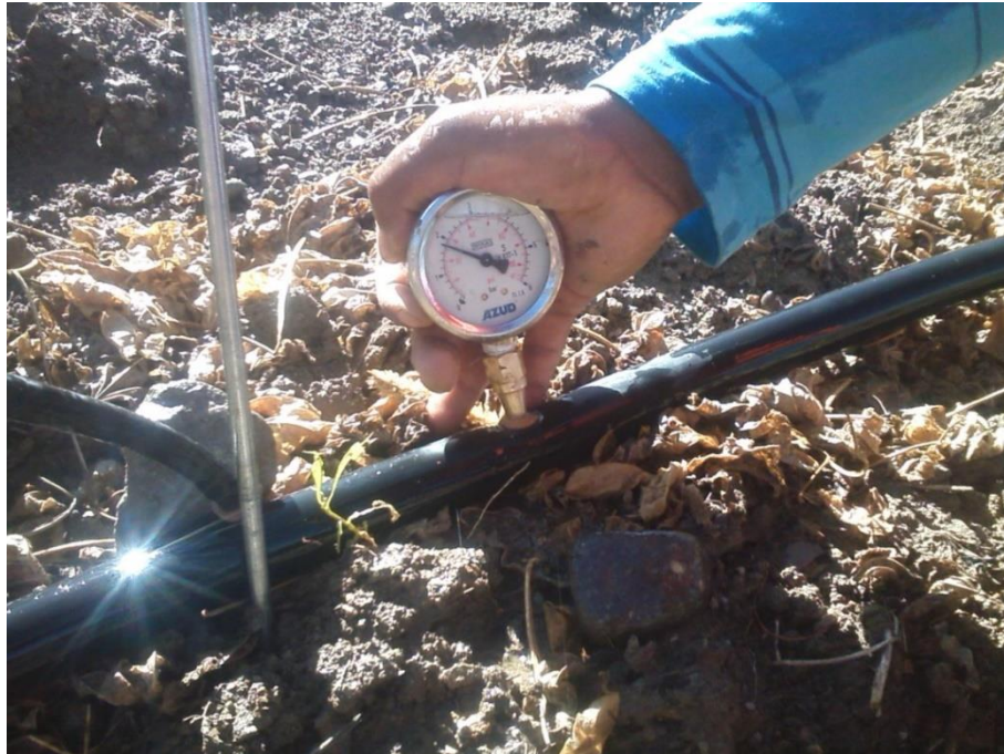
Foto 18. Evaluación de presión dinámica en funcionamiento de un turno de riego seleccionado en el riego por aspersión Xcel Wobbler, con el uso de manómetro de 6.0 bares.
