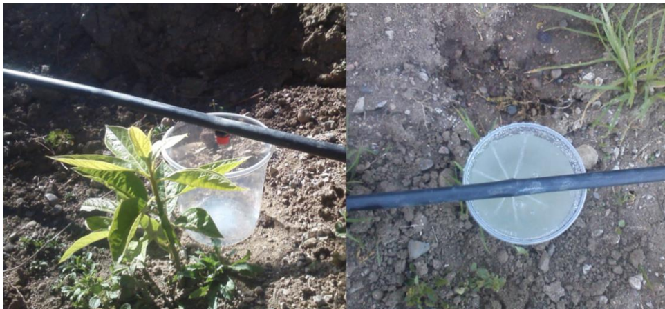
Foto 7.1.16. Evaluación de caudal en los emisores de riego por goteo con una taza de 1000 mililitros de volumen.
