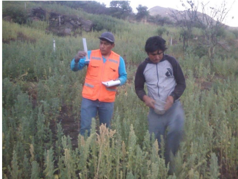
Foto 20. Lectura de lámina de agua en riego por aspersión VYR 66.
