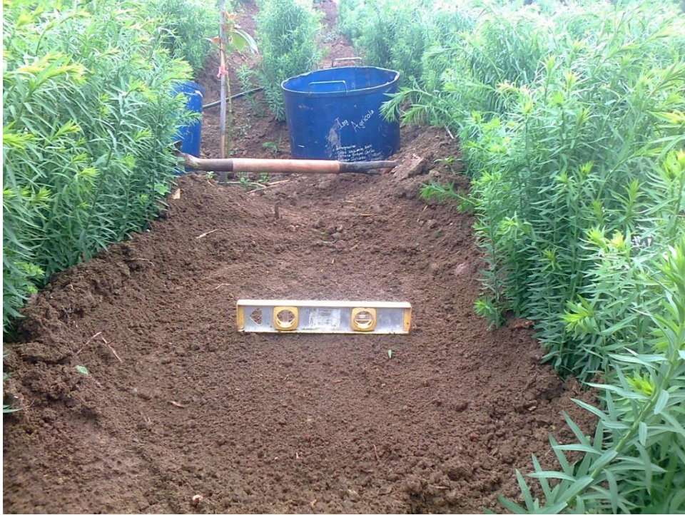
Foto 5. Proceso de nivelación de terreno para la prueba de infiltración con cilindro infiltrómetro.
