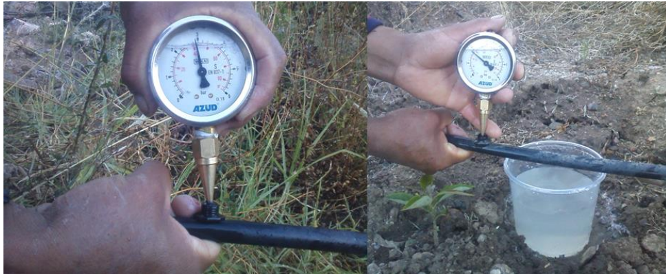
Foto 15. Evaluación de presiones dinámicas de funcionamiento en lateral de riego por goteo con el uso de manómetro de 6.0 bares.
