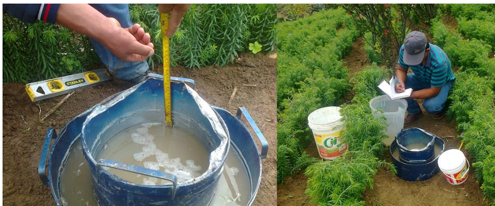
Figura 2.7: Toma de lectura de descenso de agua en lámina en el cilindro interior con flexómetro respecto a un punto de referencia al bode del cilindro interior.
