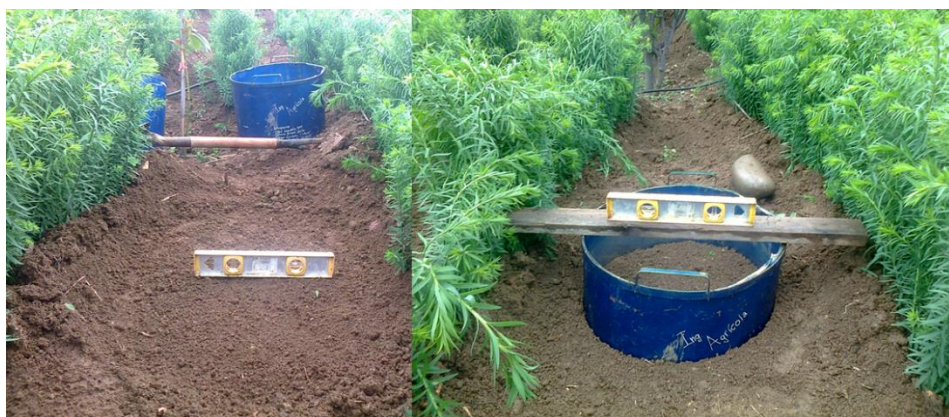
Figura 2.5: Nivelado de terreno e instalación del cilindro infiltrómetro como se observa de imagen de izquierda y derecha respectivamente
