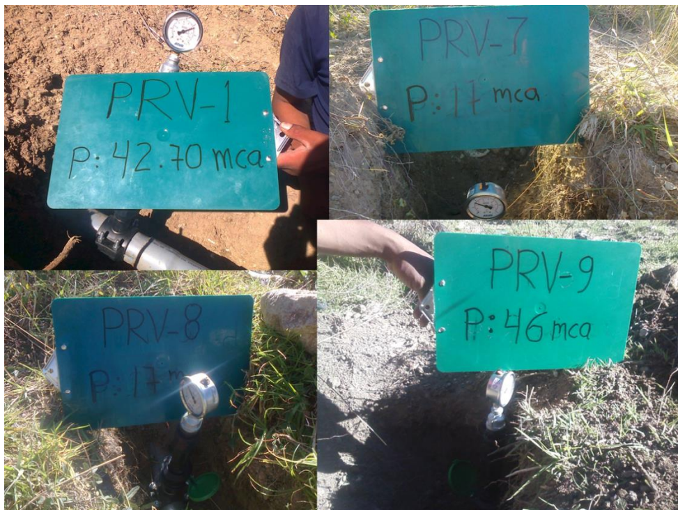
Foto 14. Evaluación de presiones dinámicas de funcionamiento en reguladoras de presión con el uso de manómetro de 6.0 bares.
