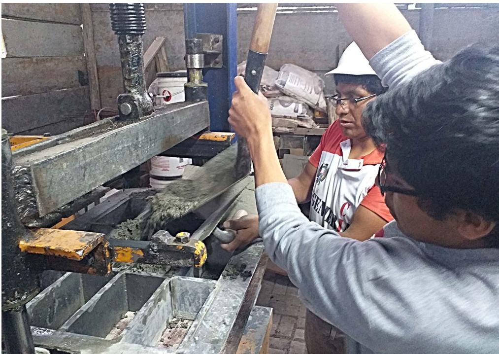
Figura E.6 Vaciado de mezcla en la adoquinera
