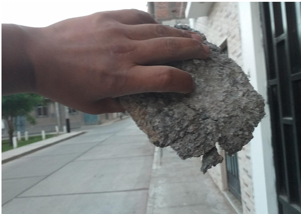
Figura E.14 Adherencia del PET en el adoquín
