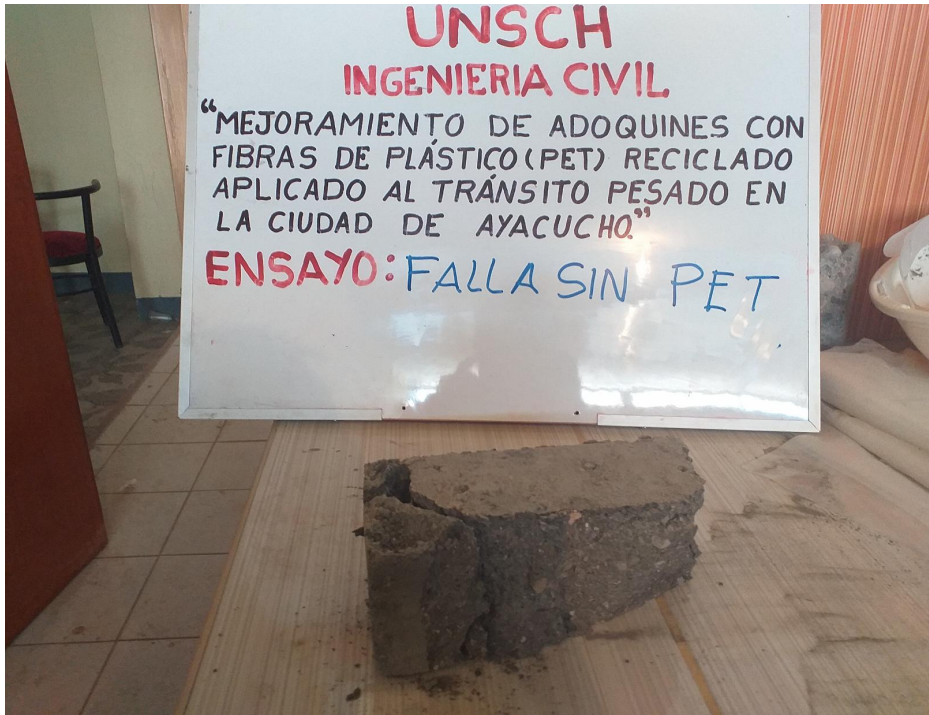
Figura 62 Tipo de falla de adoquín sin PET
