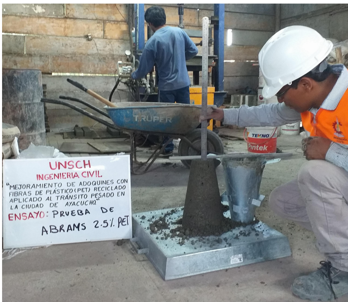
Figura 26 Ensayo de slump a los mezclas en estado plástico Fuente: Elaboración propia
