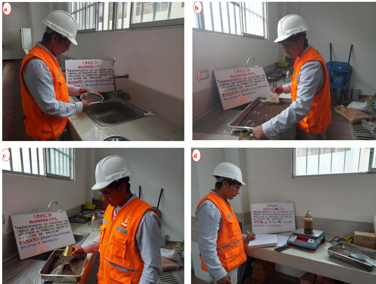
Figura 14 Proceso de determinación del peso específico real y aparente mediante procedimiento picnométrico.
