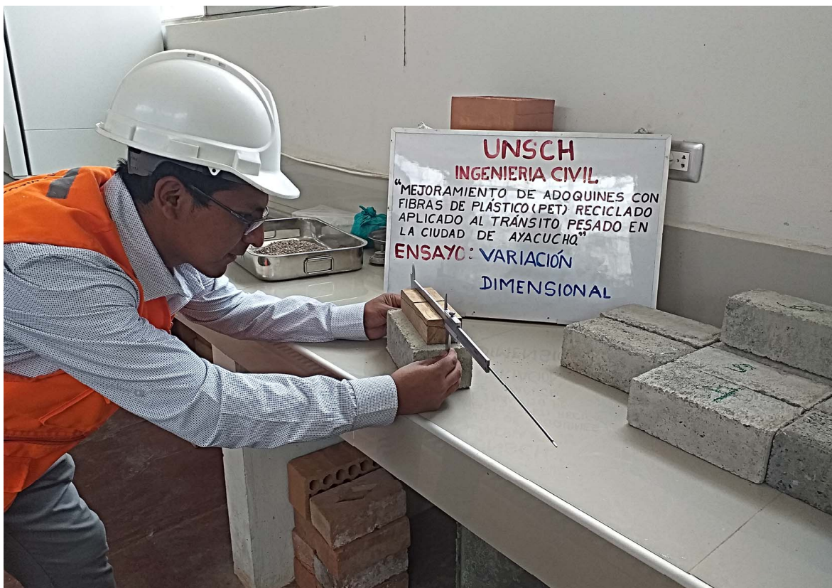
Figura 28 Ensayo de variación dimensional del adoquín
