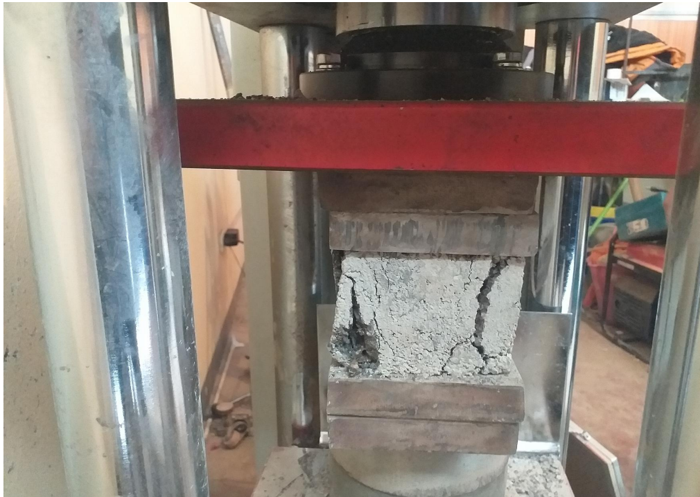
Figura E.11 Rotura de adoquines
