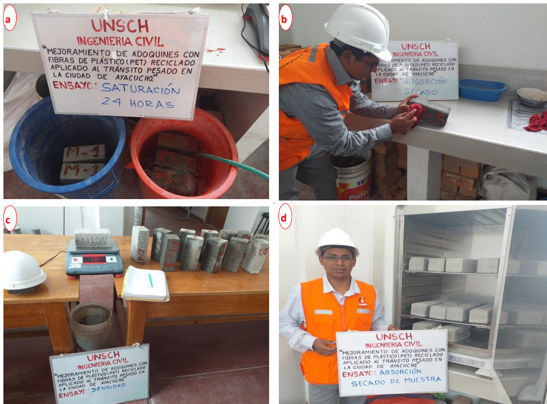
Figura 29 Proceso de determinación de Humedad natural, absorción y densidad de adoquines a) saturado del adoquín, b) secado superficial c) determinación del peso sumergido d) secado al horno antes y después de los ensayos. Fuente: Elaboración propia
