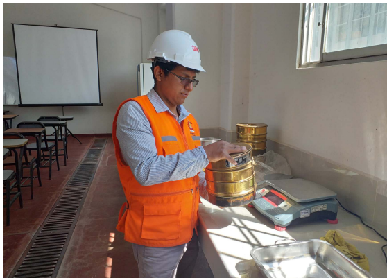
Figura 9 Ensayo de tamizado en laboratorio Civil-UNSCH
