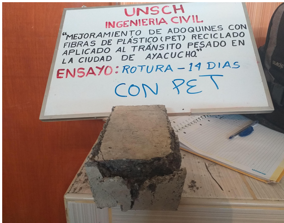
Figura 63 Tipo de falla de adoquín con PET
