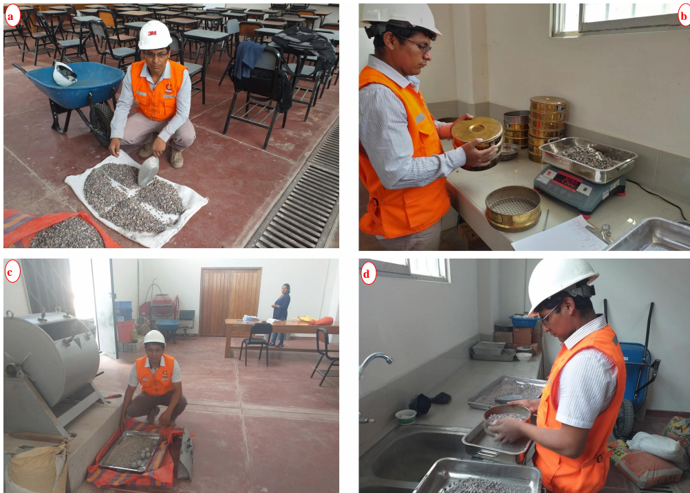
Figura 15 Proceso de determinación desgaste por abrasión del agregado grueso.
