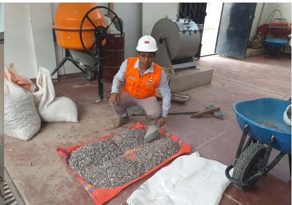
Figura 10 Ensayo de cuarteo en laboratorio Civil-UNSCH
