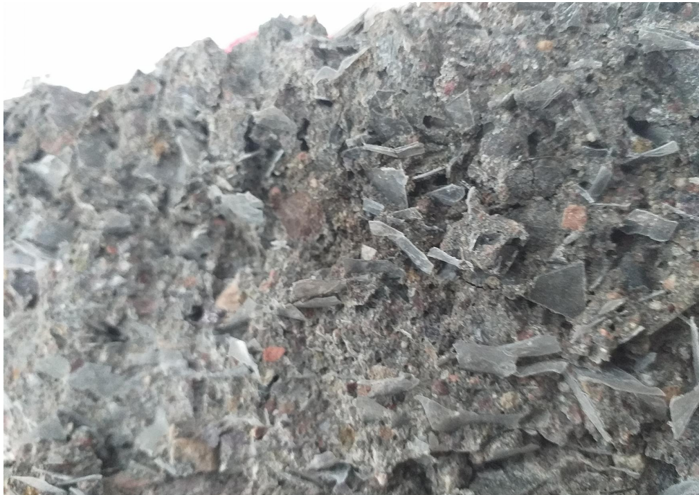
Figura E.12 influencia del tamaño de PET en los adoquines.
