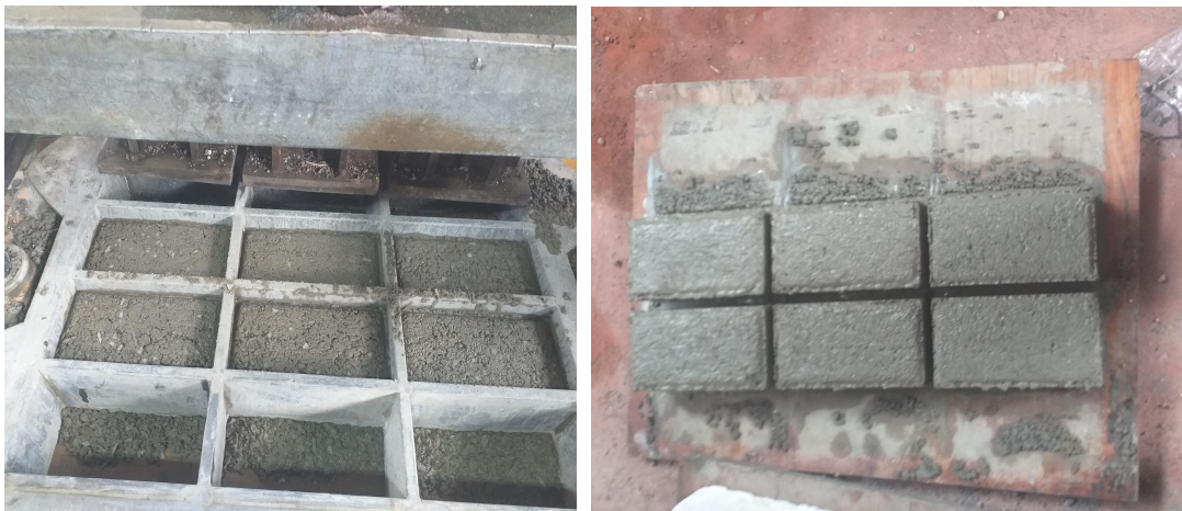
Figura E.10 Desmoldado
