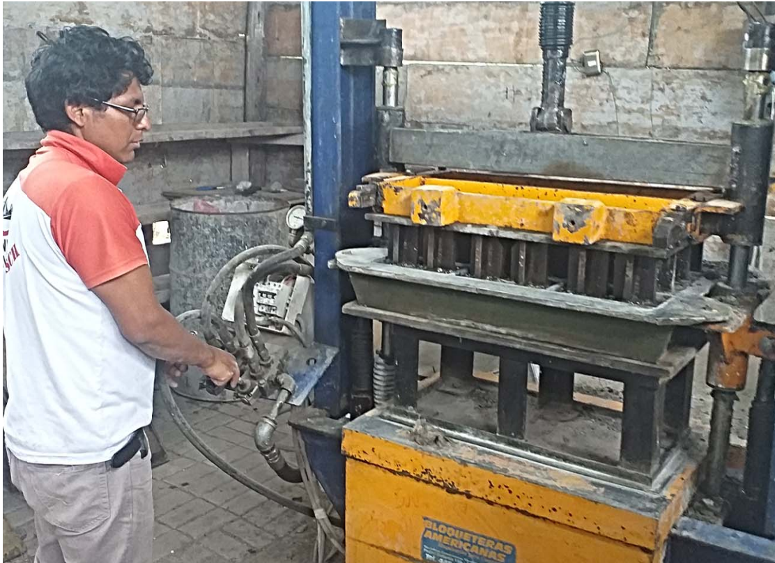
Figura E.9 Vibrado y compactado
