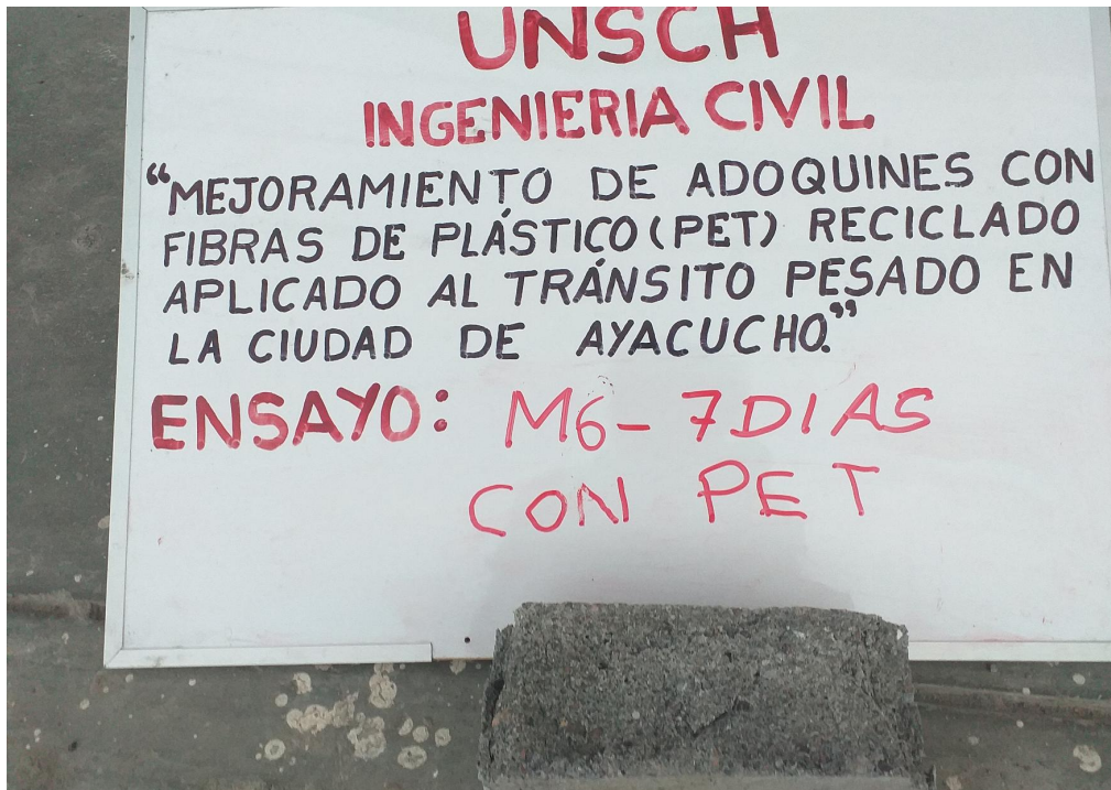
Figura E.13 Influencia del tamaño de PET en adoquines
