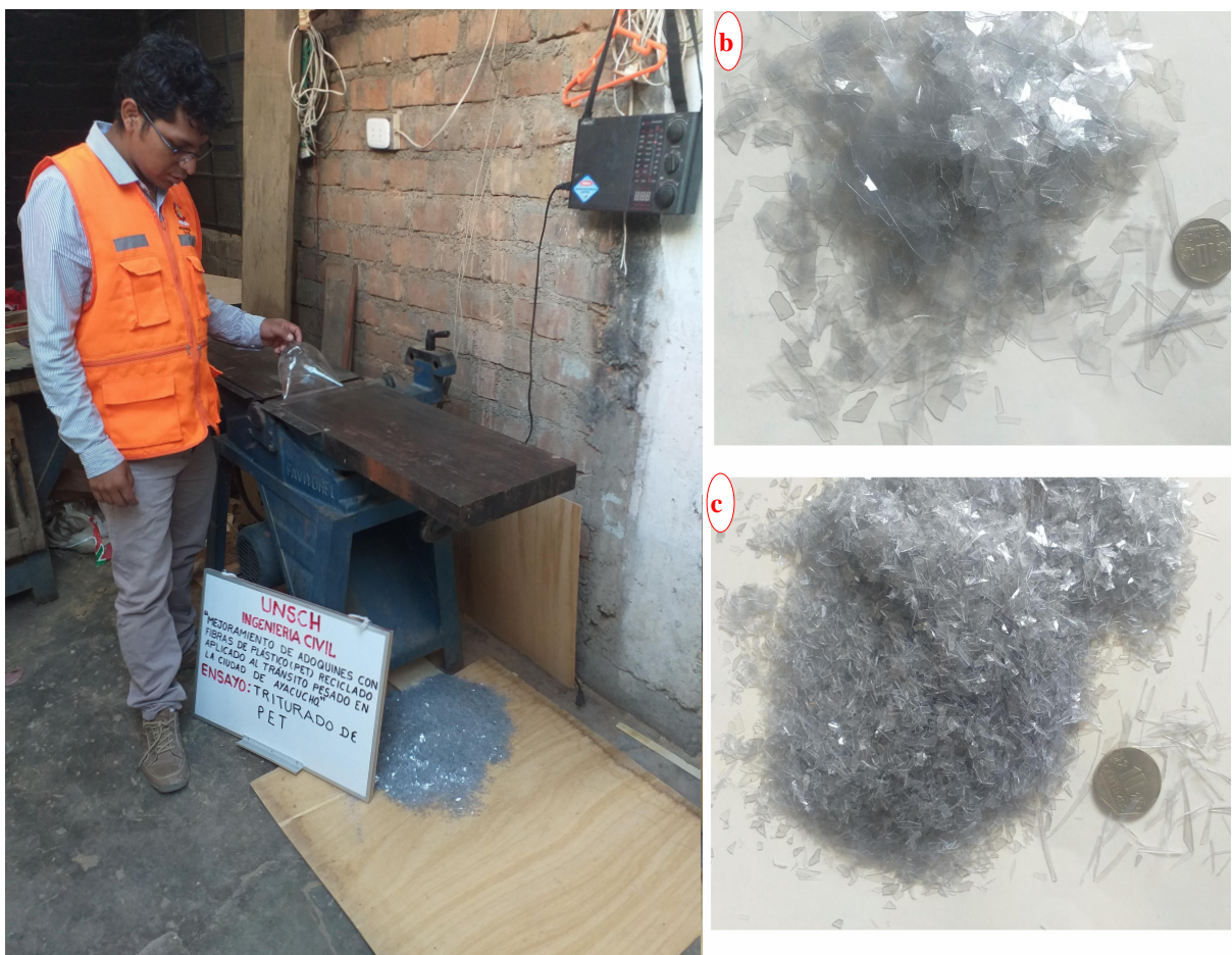
Figura 18 Proceso de trituración del PET
