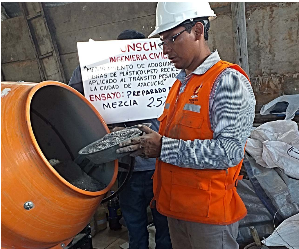
Figura E.4 Batido de materiales en la mezcladora, el batido de los agregados en la mezcladora se realiza aproximadamente por 10 minutos, echando a la mezcladora primero los agregados junto con el cemento y dejar batir por 1 minuto, luego se agrega el agua con el aditivo de manera paulatina y se deja batir por un promedio de 10 minutos hasta que forme una pasta uniforme sin grumos.
