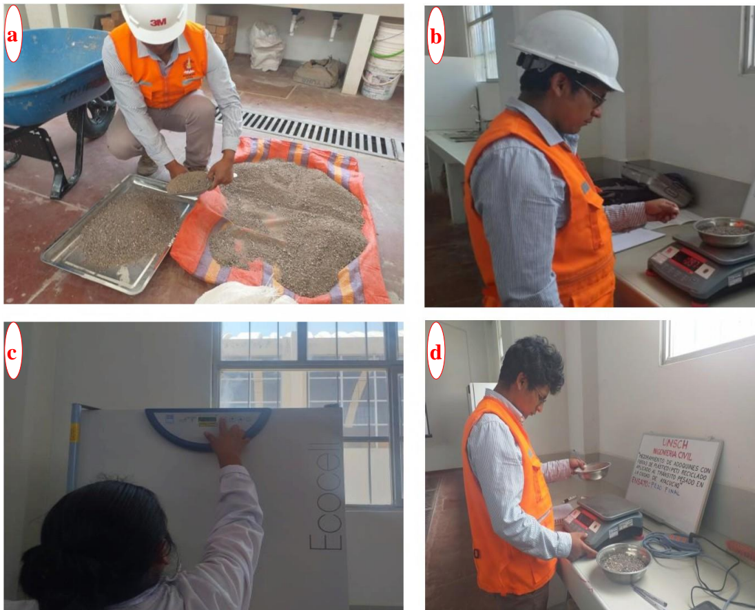
Figura 12 Proceso para determinar el contenido de agua del agregado.
