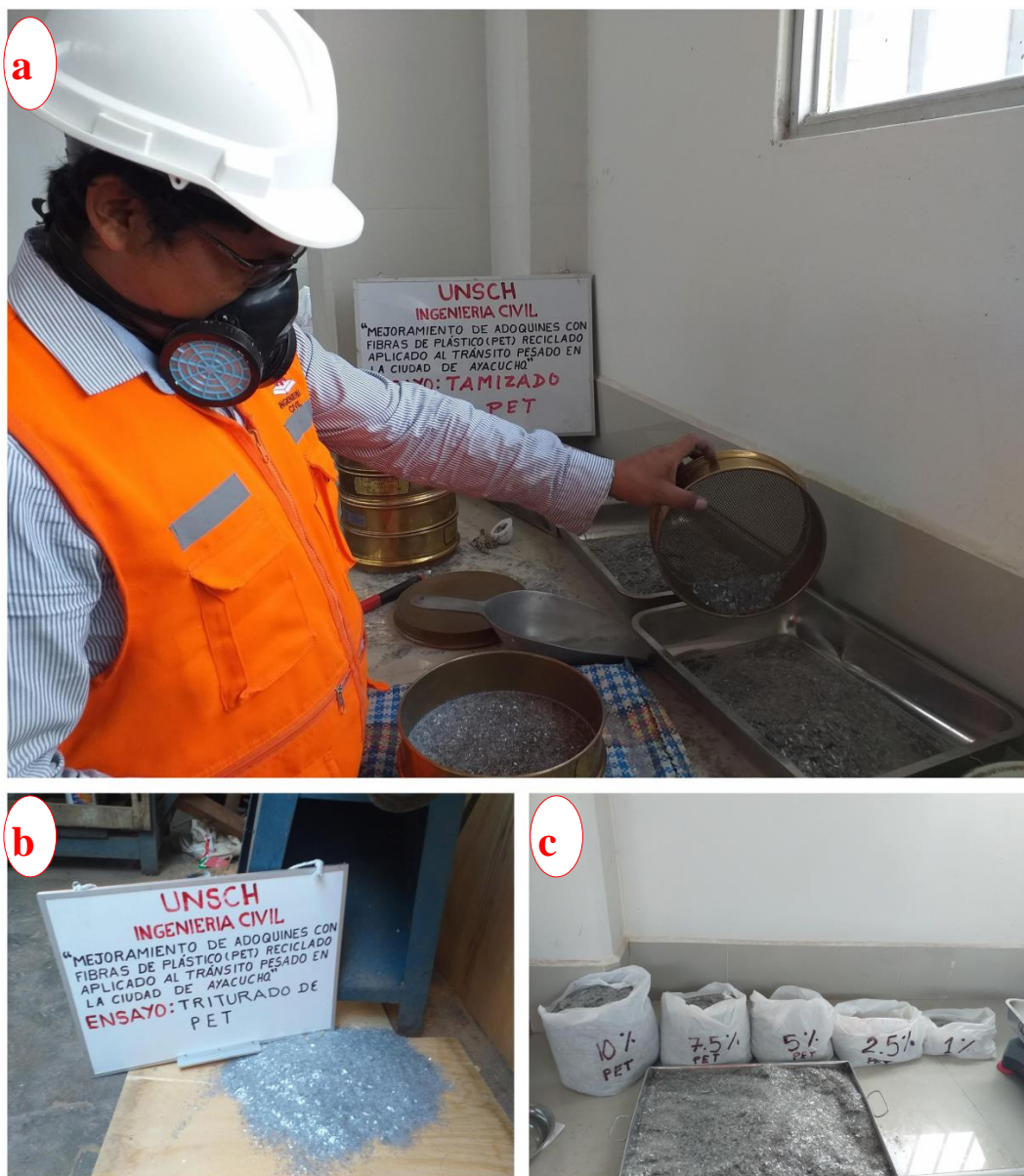
Figura 19 Proceso de tamizado del PET
