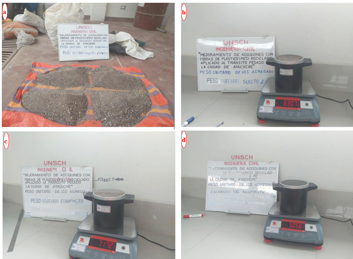
Figura 13 Cuarteo, calibración, Pesaje de pesos sueltos y compacto.
