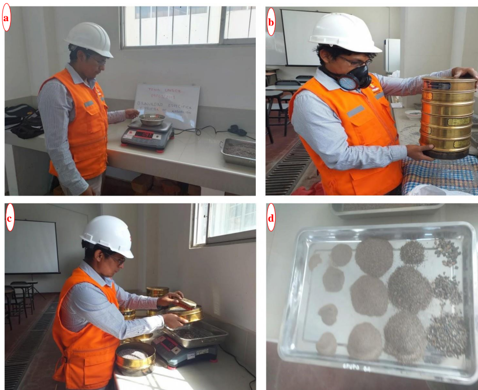
Figura 11 Proceso de tamizado de agregados
